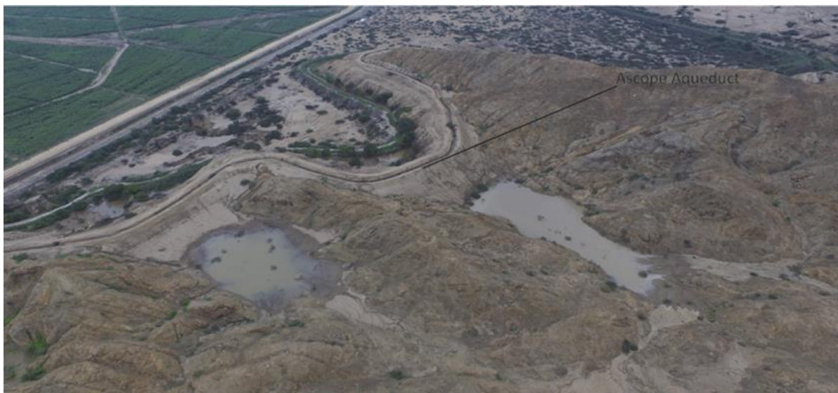
Obr. 24: Fotografie erozních roklí naplněných povodňovou vodou z El Niño Costero v roce 2017 přehrazených prehispánským akvaduktem Ascope
