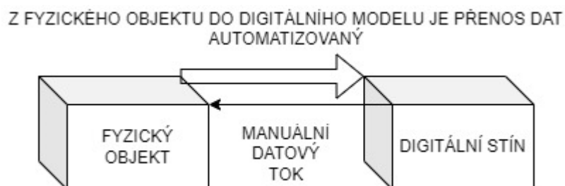
Obr. 2: Ilustrace přenosu dat mezi fyzickým objektem a digit. stínem - vlastní tvorba dle [5]
