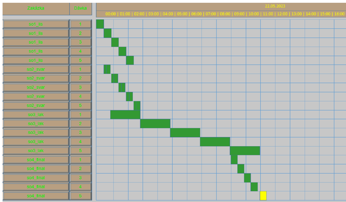
Obr. 52: Ganttový diagram po úpravě – odložený start poslední operace (vlastní tvorba)
