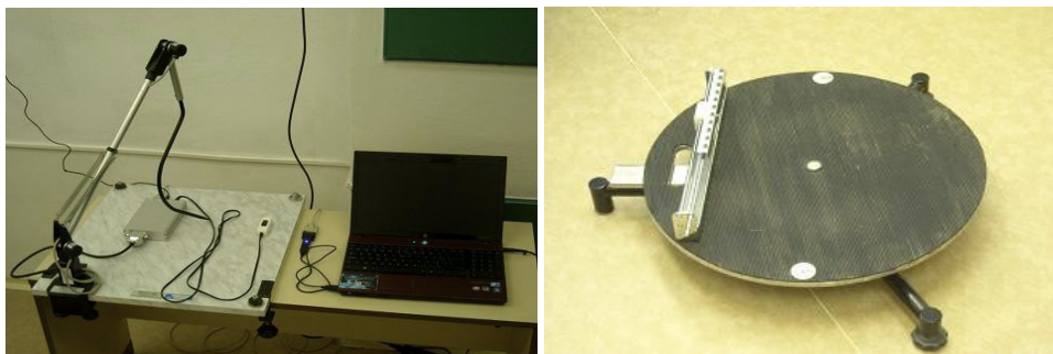
Obrázek 27. Polohový snímač, základní deska, EVJ, osobní počítač [vlevo], otočná plošina s aretačním zařízením [vpravo] (fotoarchiv autorky, 2010).
