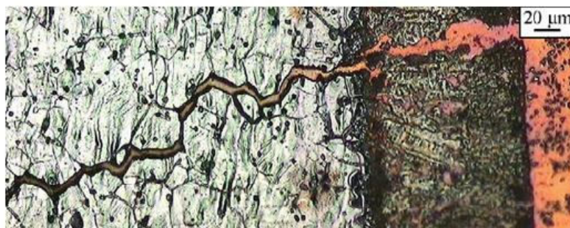
Obr. 9 Interkrystalická penetrace Cu uvnitř HAZ oceli [48].
