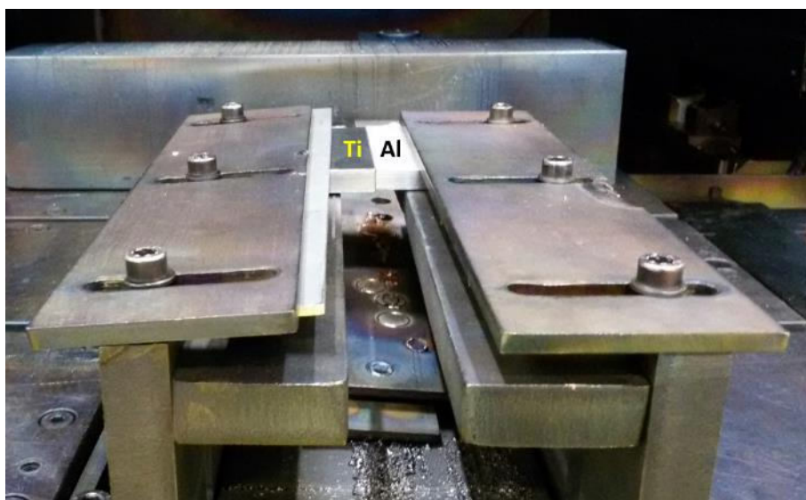
Obr. 66 Upnutí svařovaných materiálu v pracovní komoře univerzálního zařízení K14 EBG 45-150 (TU Graz).
