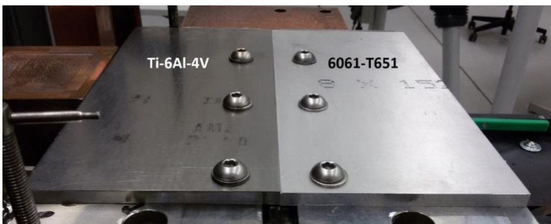
Obr. 107 Polotovaz pro výrobu zkušebních těles pro hodnocení mechanických vlastností heterogenních svarových spojů vzorků V-1 a V-2.
