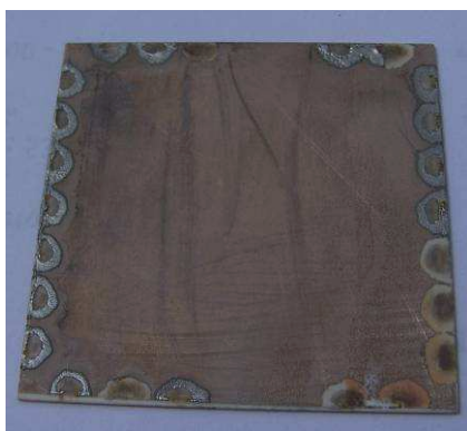
Obr. 33: Spodní strana desky keramického substrátu, po teplotním cyklování
