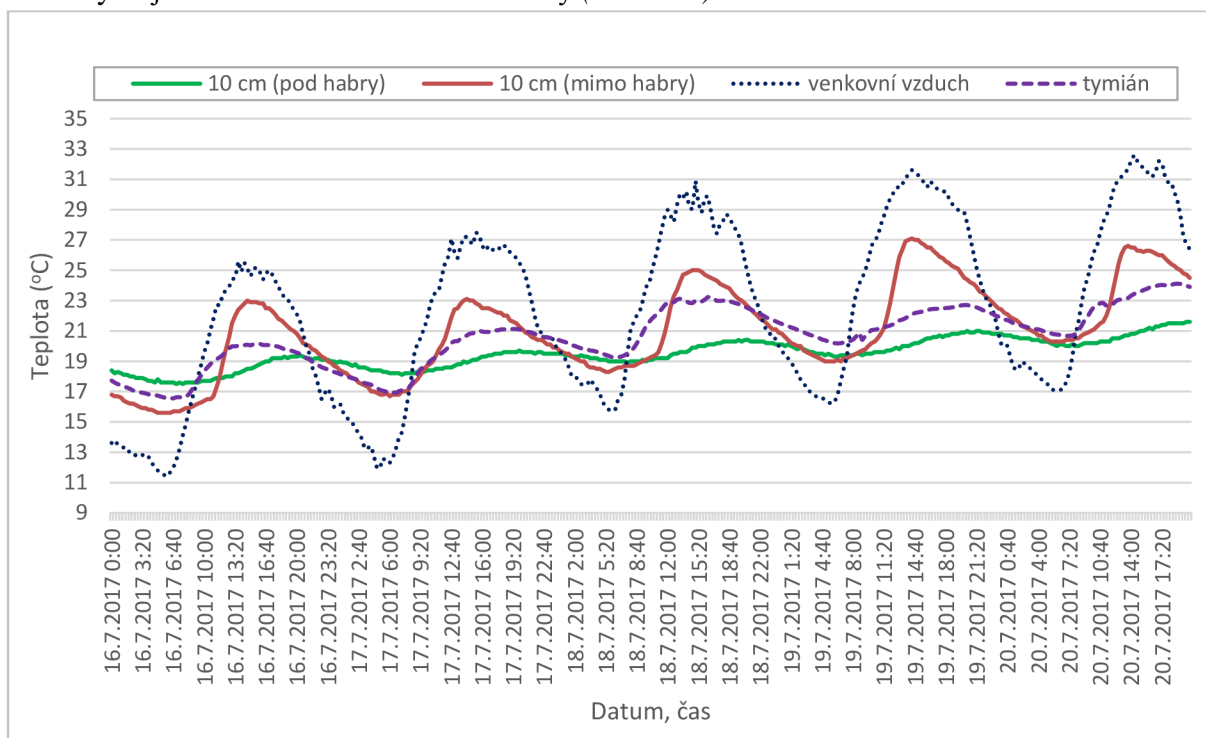
Obr. 4.27- Průběh teplot v substrátu (senzor (1) - 10 cm pod habry, senzor(2)- 10 cm mimo habry, teplotní čidlo (3) umístěné těsně pod povrchem v tymiánu) a průběh teplot venkovního vzduchu (16.7-20.7.2017)
