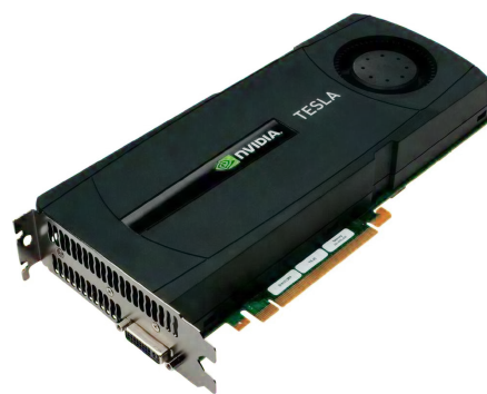
Obrázek 5.14: GPU nVIDIA Tesla C2075 s 448 CUDA jádry a 6 GB GDDR paměti (zdroj: http://www.nvidia.com/ ).
