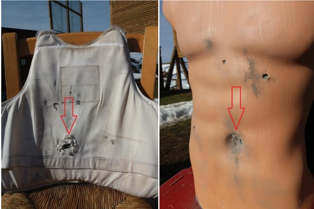
Obrázek 110 – poškozená vesta z vnitřní strany a průstřel trupu 132
