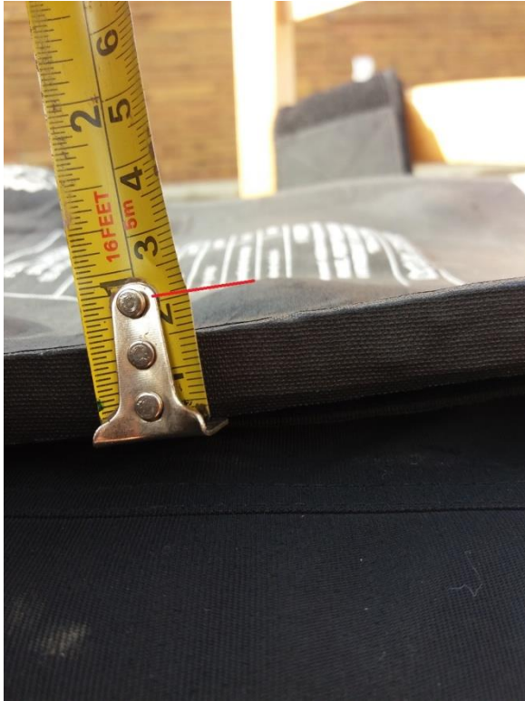
Obrázek 68 – vydutí balistického panelu směrem „do těla“ 90
