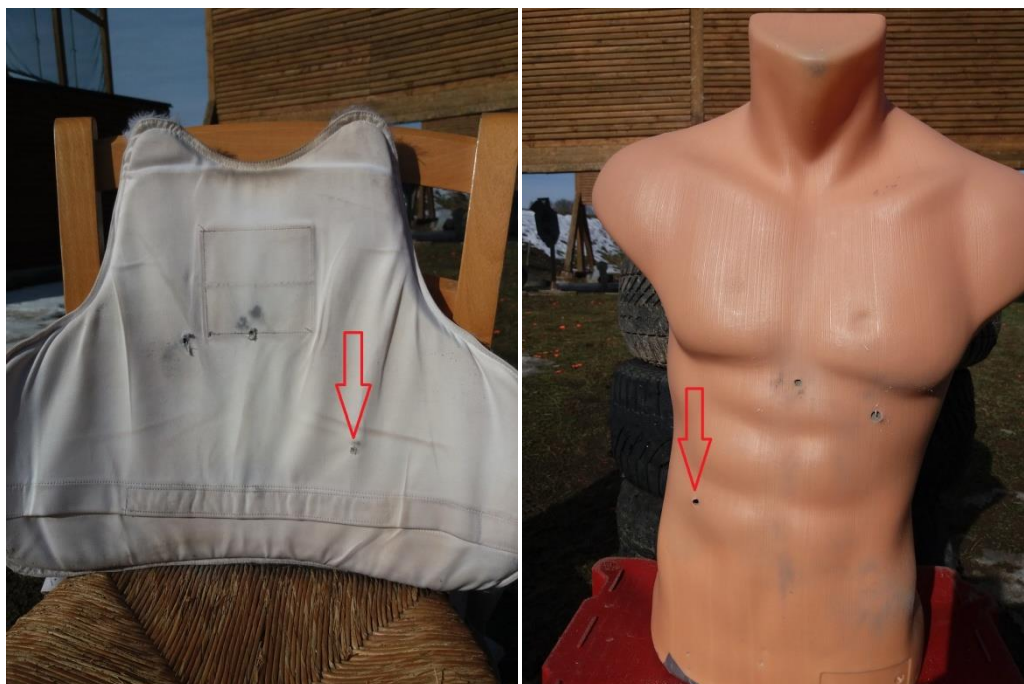
Obrázek 107 – poškozená vesta z vnitřní strany a průstřel trupu 129
