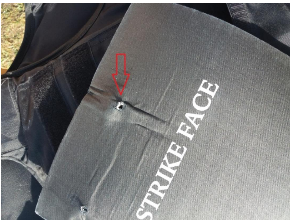
Obrázek 42 – místo zásahu balistického panelu 64
