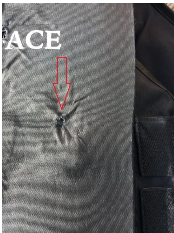
Obrázek 67 – místo zásahu balistického panelu 89
