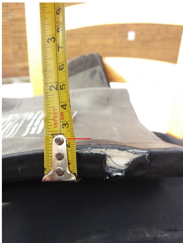
Obrázek 73 – vydutí balistického panelu směrem „do těla“ 95
