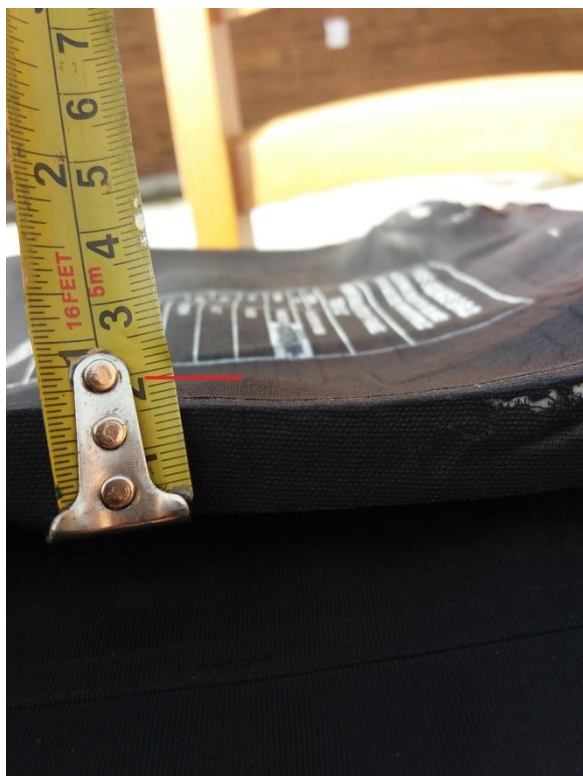
Obrázek 78 – vydutí balistického panelu směrem „do těla“ 100
