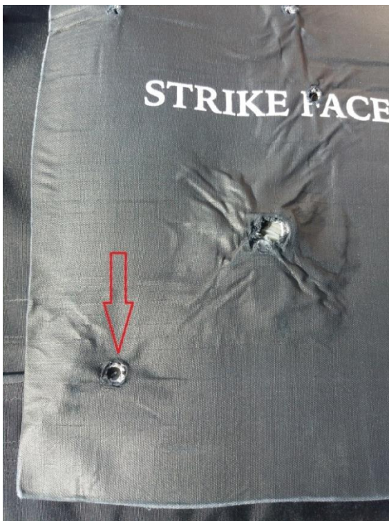
Obrázek 62 – místo zásahu balistického panelu 84
