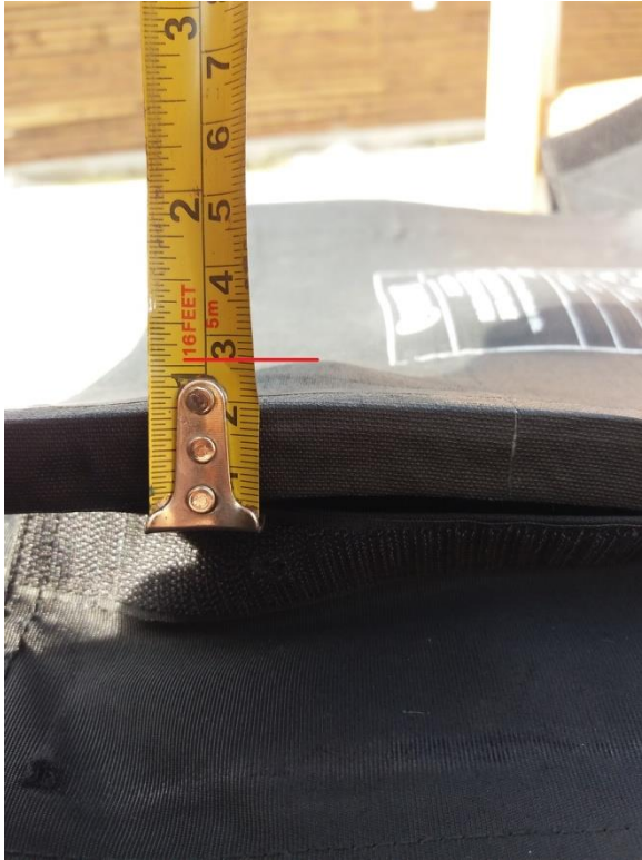
Obrázek 63 – vydutí balistického panelu směrem „do těla“ 85
