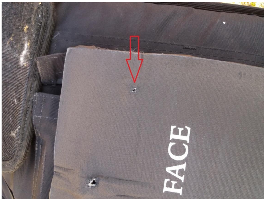
Obrázek 47 – místo zásahu balistického panelu 69
