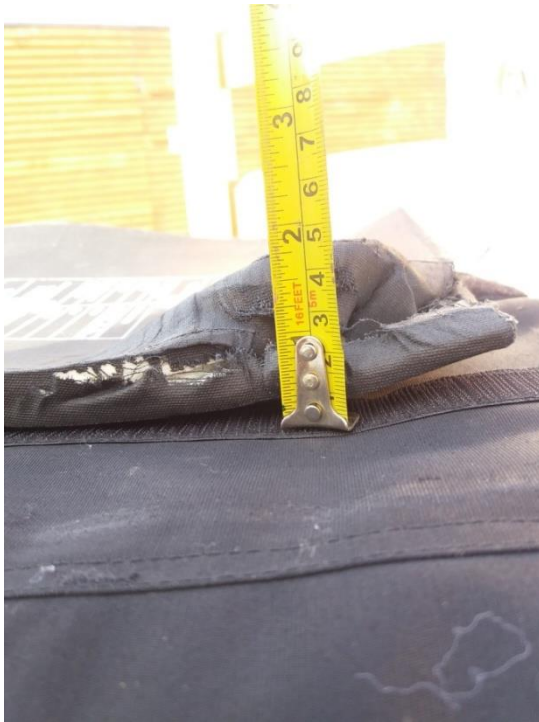
Obrázek 38 –vydutí balistického panelu směrem „do těla“ 60
