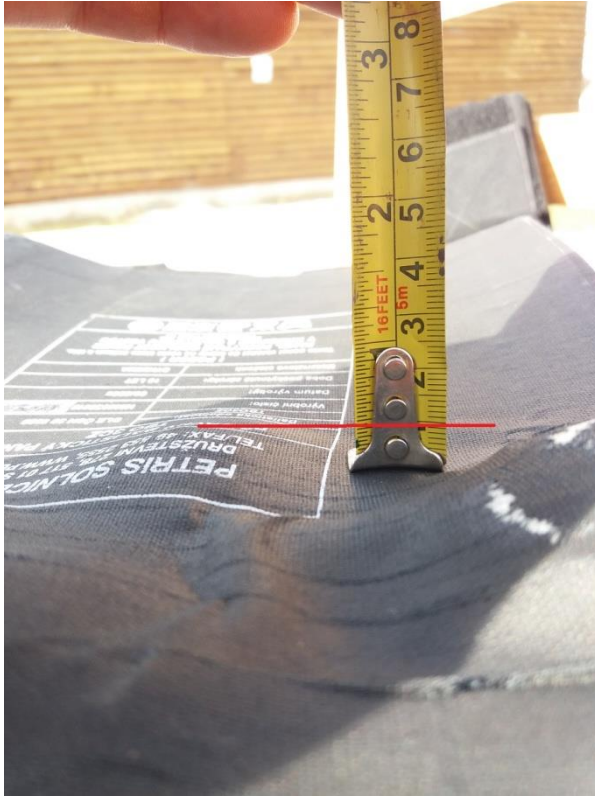
Obrázek 53 – vydutí balistického panelu směrem „do těla“ 75
