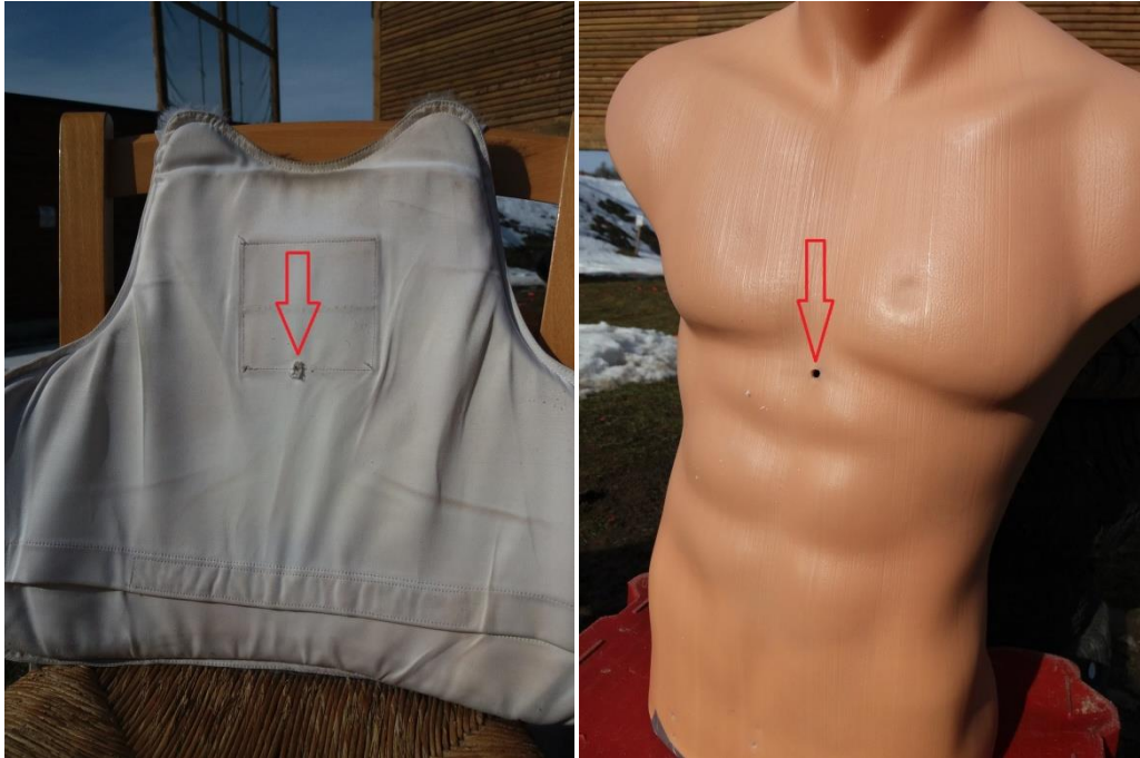
Obrázek 101 – poškozená vesta z vnitřní strany a průstřel v trupu 123
