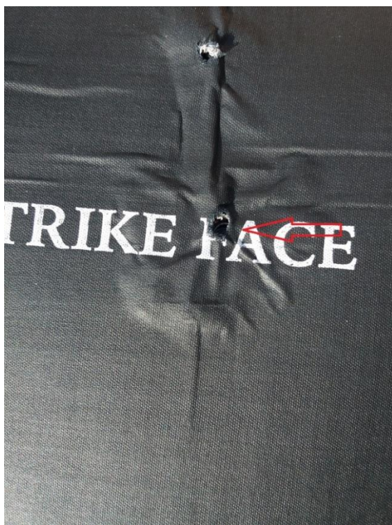
Obrázek 52 – místo zásahu balistického panelu 74
