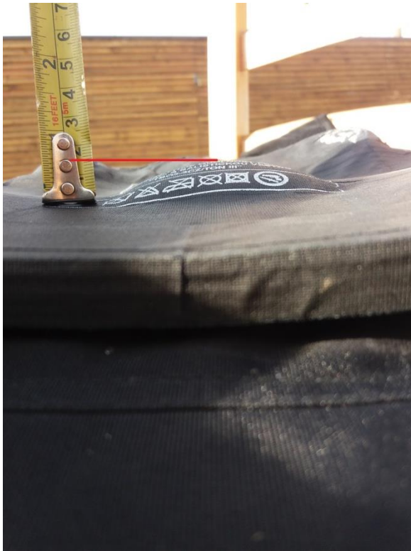
Obrázek 58 – vydutí balistického panelu směrem „do těla“ 80
