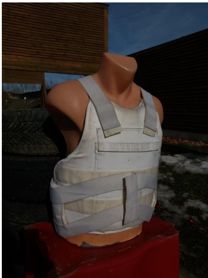
Obrázek 83 – balistická vesta pro skryté nošení připravená na test 105
