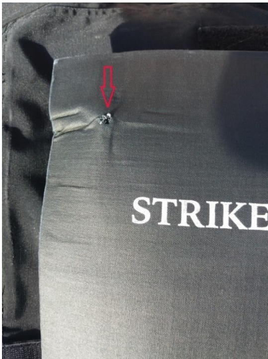
Obrázek 37 – místo zásahu balistického panelu 59
