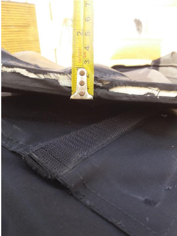
Obrázek 43 – vydutí balistického panelu směrem „do těla“ 65
