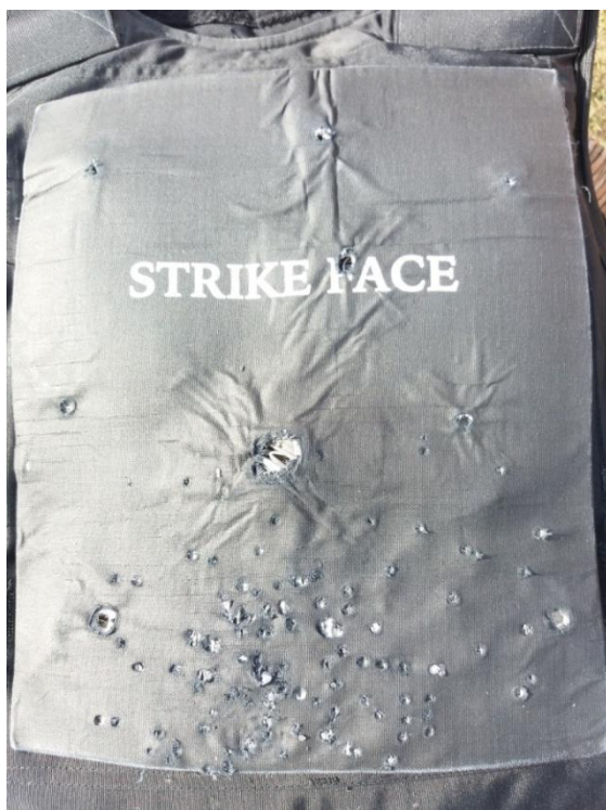
Obrázek 82 – místo zásahu balistického panelu 104
