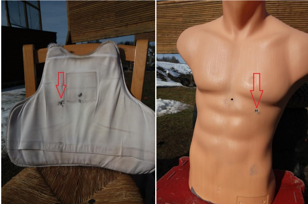
Obrázek 104 – poškozená vesta z vnitřní strany a průstřel v trupu 126
