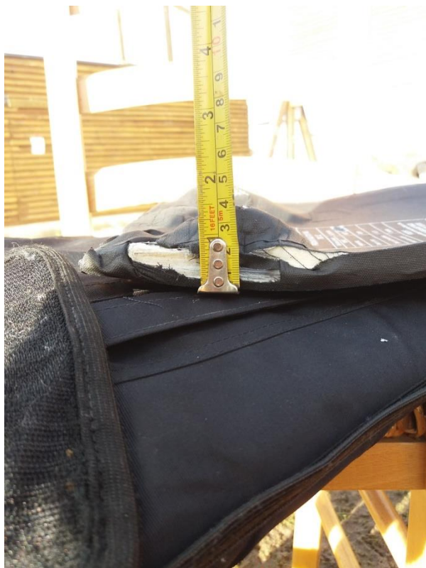
Obrázek 48 – vydutí balistického panelu směrem „do těla“ 70
