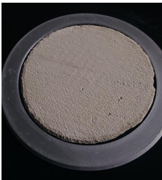
Obrázek č.7: Vzorek před nanesením tenkovrstvé omítky
