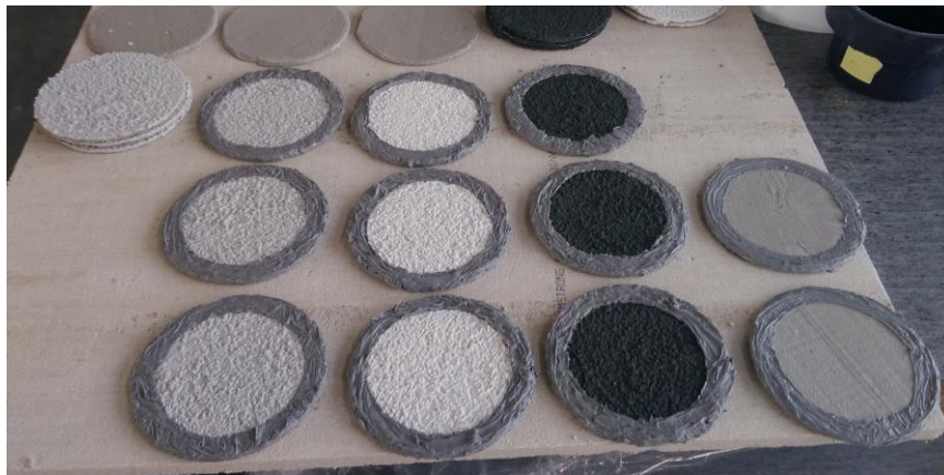
Obrázek č.13: Všechny sady vzorků s vyznačenou zkoušenou plochou
