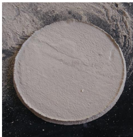
Obrázek č.5: Vzorek základní vrstvy po sejmutí z folie a před zabroušení hran
