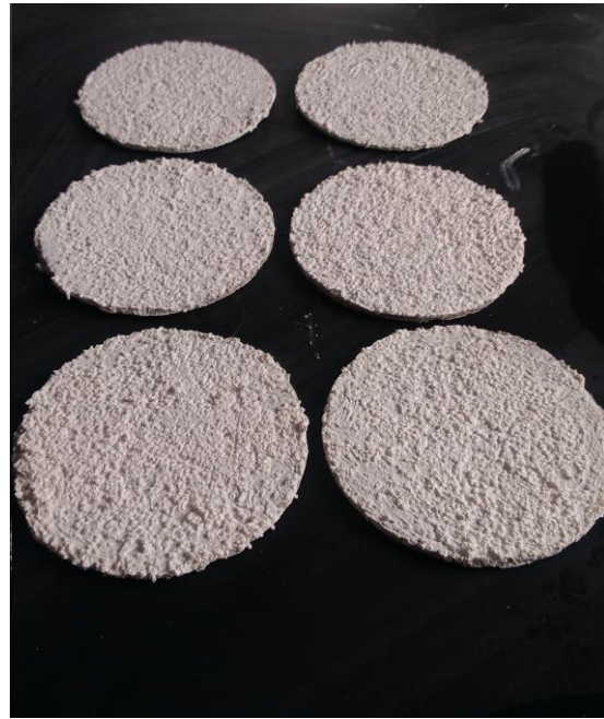
Obrázek č.10: Sada vzorků s omítkou bílé barvy
