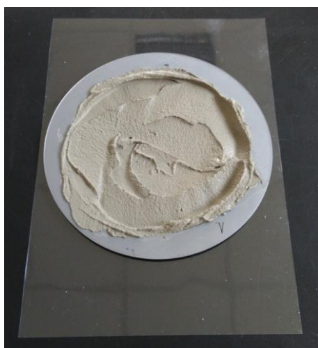
Obrázek č.2: Vyplněná forma cementovou stěrkou do cca \frac{1}{2} výšky
