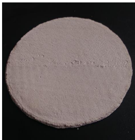
Obrázek č.6: Zabroušený vzorek opatřený penetračním nátěrem
