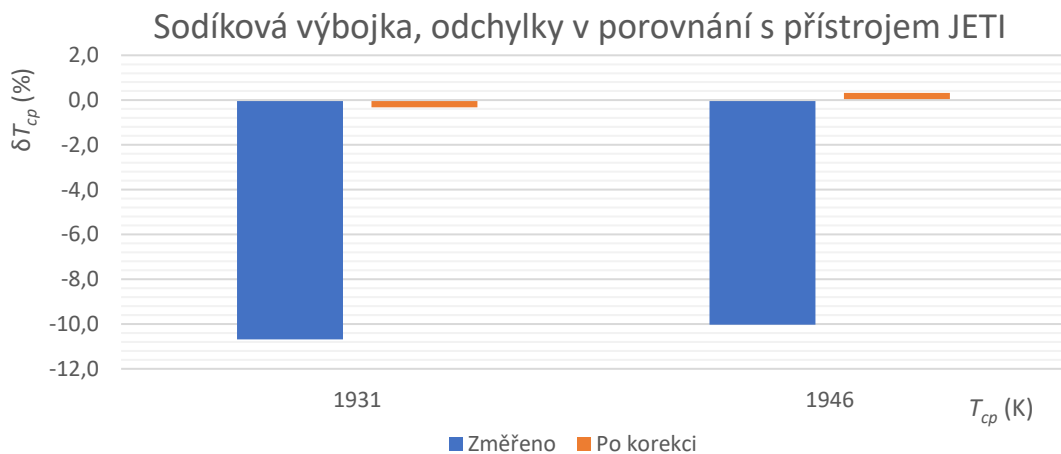
Obr. 77 Odchylky v porovnání s přístrojem JETI pro sodíkovou výbojku
