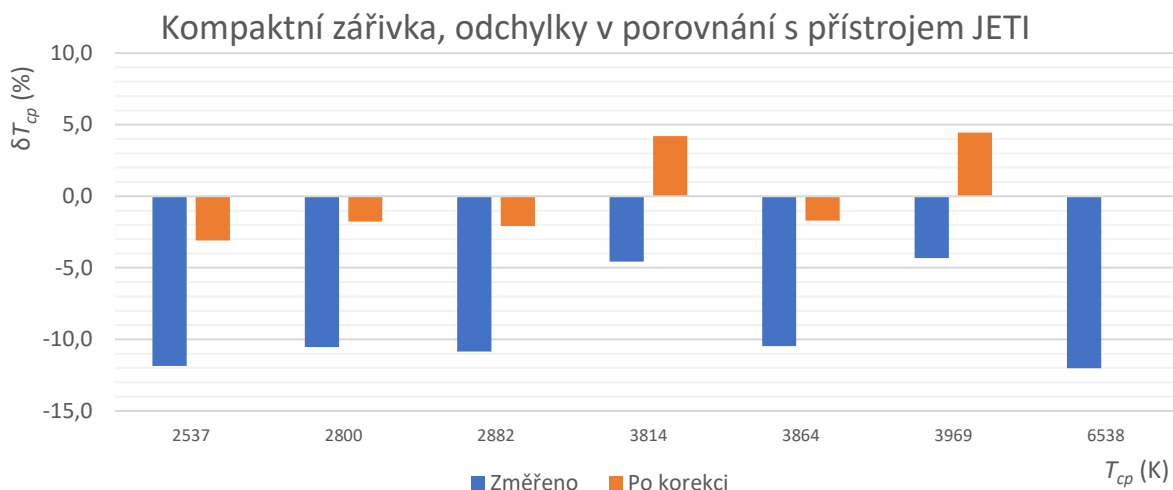
Obr. 78 Odchylky v porovnání s přístrojem JETI pro kompaktní zářivku
