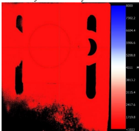
Obr. 81 Snímek z měření vybuzení modrého kanálu, při měření LED Vitae 1600 K, snímek je zpracován v před vývojové verzi programu LumiDISP
