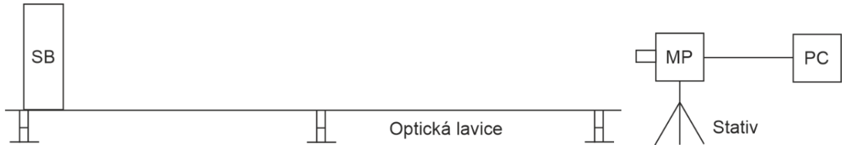
Obr. 48 Schéma měření světelného boxu na optické lavici
