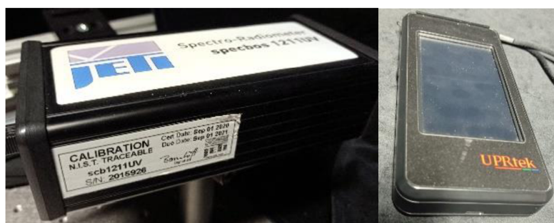
Obr. 59 Spektroradiometr a) JETI, b) UPRtek
