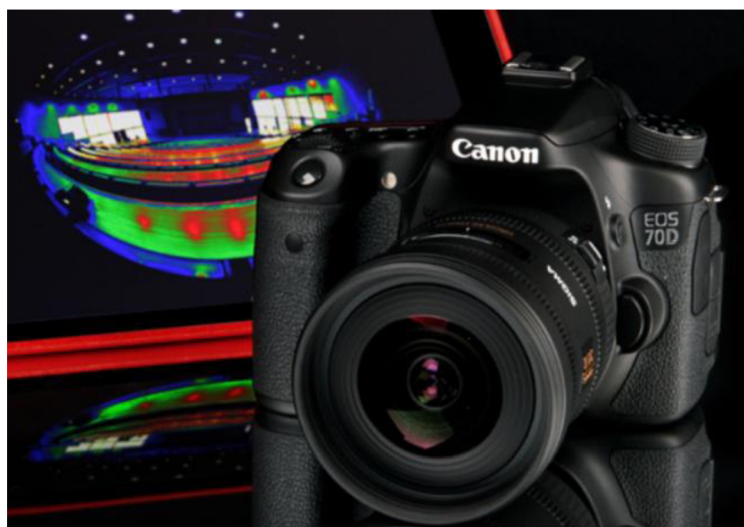
Obr. 29 Jasová DSLR kamera LMK mobile air [5]
