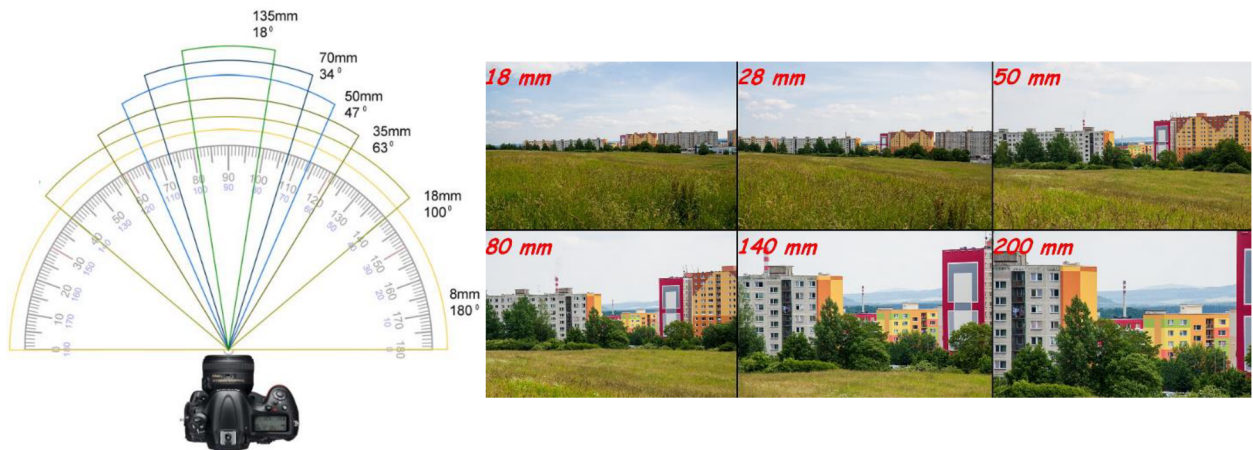
Obr. 42 Změna ohniskové vzdálenosti se zorným úhlem [39]
