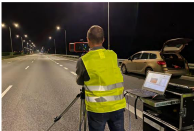
Obr. 34 Měření s jasovou kamerou GL Opticam 3.0 v terénu [24]
