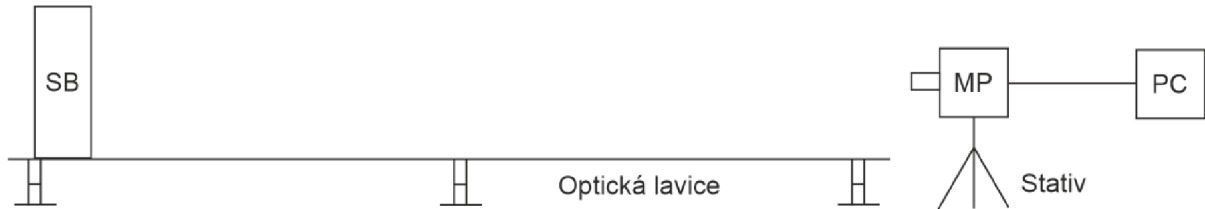
Obr. 48 Schéma měření světelného boxu na optické lavici
