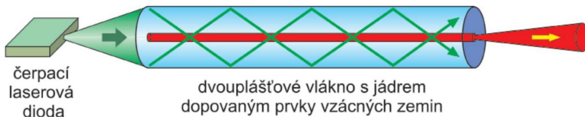
Obr. 17 Princip buzení vláknového laseru [49]
