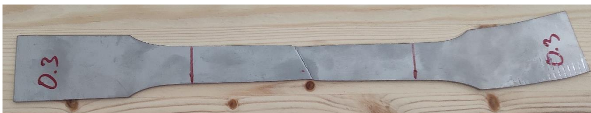
Obr. 38 Vzorek po tahové zkoušce základního materiálu
