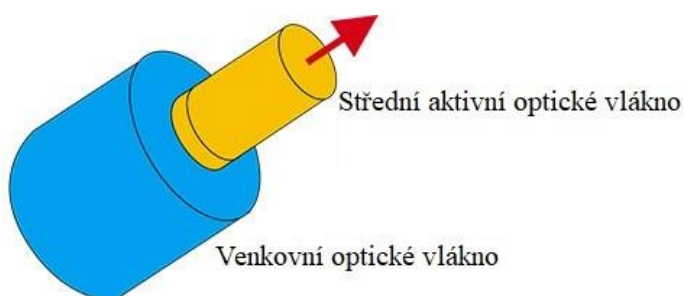
Obr. 16 Struktura dvojitého optického vlákna [48]
