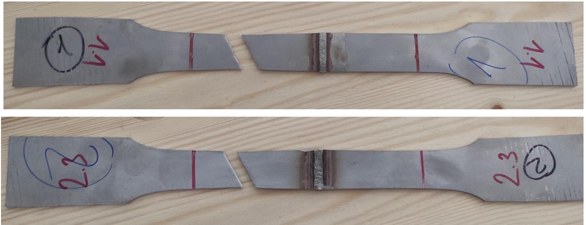
Obr. 46 Vzorky č. 1B a 2B po tahové zkoušce
