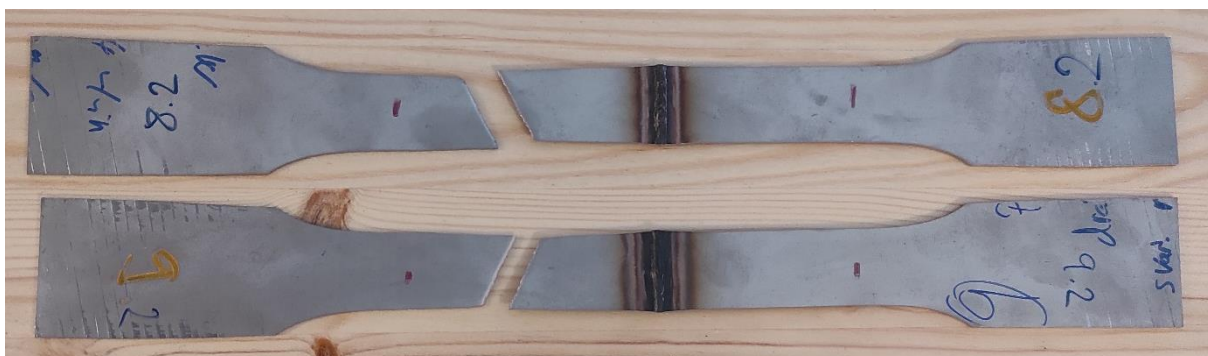
Obr. 40 Vzorky č. 8 a 9 po tahové zkoušce
