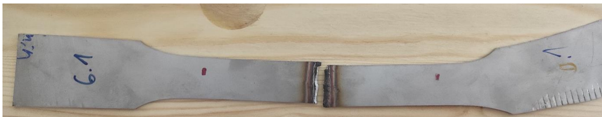
Obr. 39 Vzorek č. 6 po tahové zkoušce
