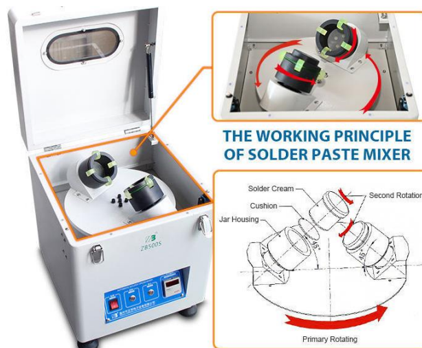
Obrázek 2.3 Mixér na pájecí pastu [36]
