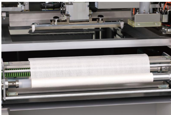
Obrázek 3.3 Čištění šablony při tisku pájecí pasty [32]
