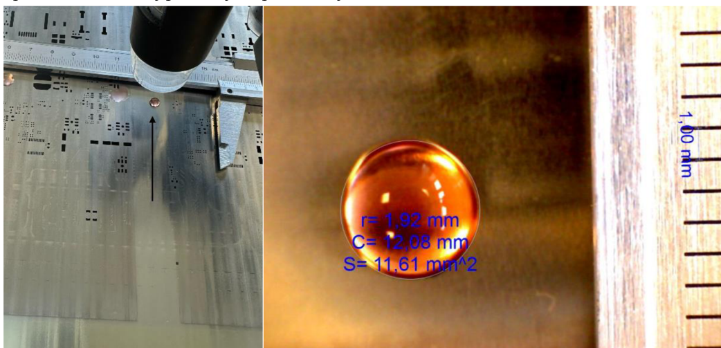
Obrázek 6.8 Měření hydrofobnosti povrchu šablony s povrchovou úpravou plasma-coatingem
