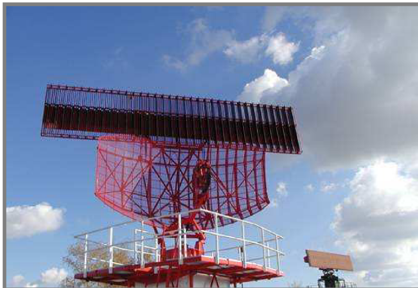
Obr.1-6 Primární přehledový radar RL-2000 [41]
