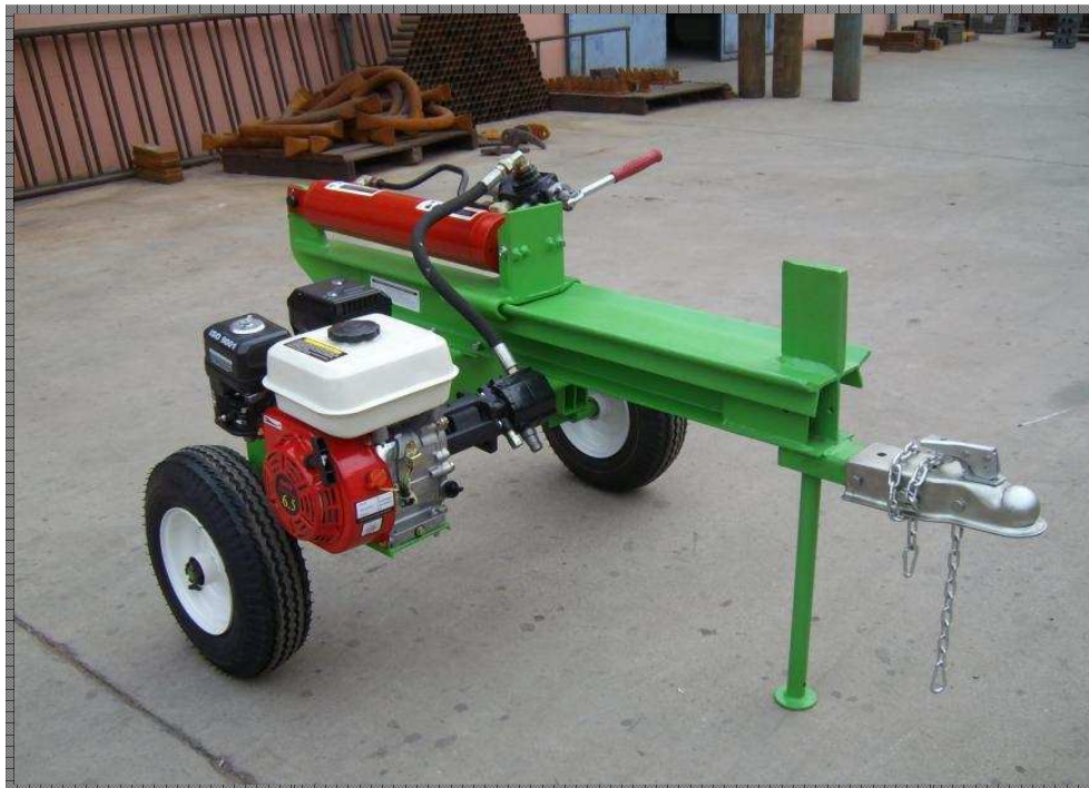
Obr. 1.4 štiepačka poháňaná spaľovacím motorom od firmy Luckamp Industry [6]
