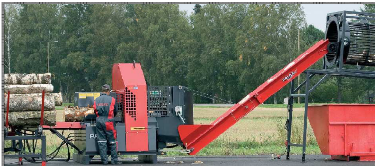
Obr. 1.12 štiepačka PALAX POWER 100S so silou 16 t, podávačom polien, dopravníkovým pásom a bubnom na čistenie dreva [13]
