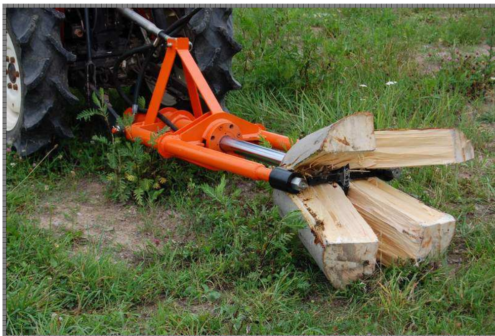
Obr. 1.5 zariadenie od firmy Kovaco poháňané tlakom z čerpadla od iného zariadenia [7]
