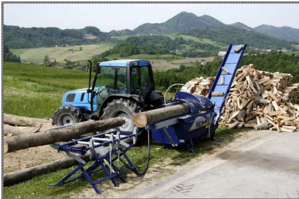
Obr. 1.10 štiepačka TAJFUN RCA 320 s podávačom polien a dopravníkovým pásom, sila 10 t [11]
