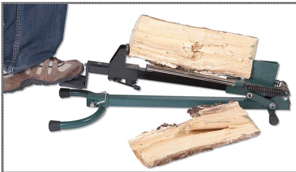
Obr. 1.2 Nohou obsluhované mechanické zariadenie firmy Quality Craft [4]
