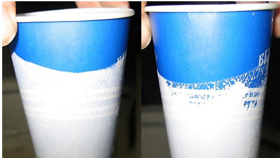
Obr. 23 Dobrá smáčivost (vlevo) a špatná smáčivost (vpravo) [15]
