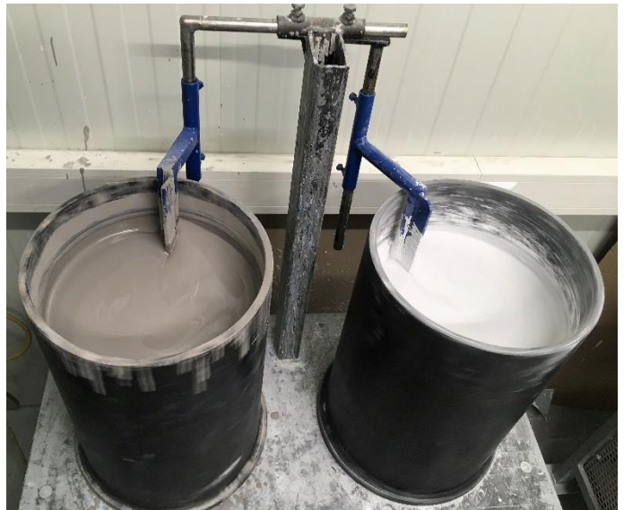
Obr. 10 Nádoby s keramickou suspenzí
