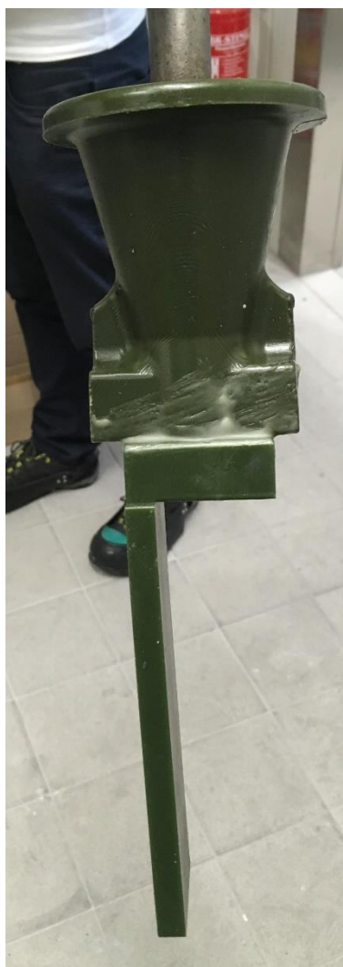
Obr. 33 Voskový model pro výrobu vzorků na zkoušku pevnosti v ohybu
