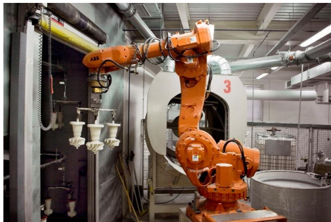
Obr. 7 Robotizované pracoviště obalovny [7]
