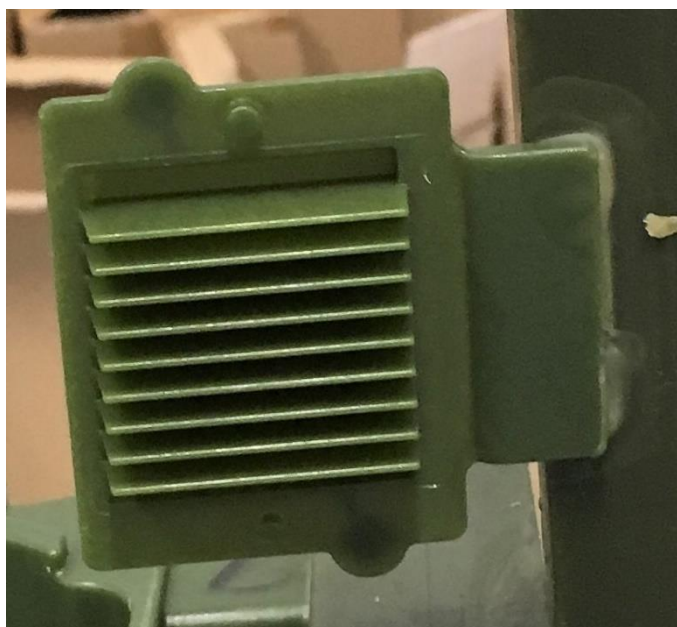
Obr. 32 Voskový model chladiče
