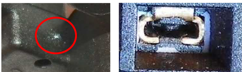
Obr. 5.10 Nedolítí pouzdra vlevo, zalitý kontakt vpravo.
