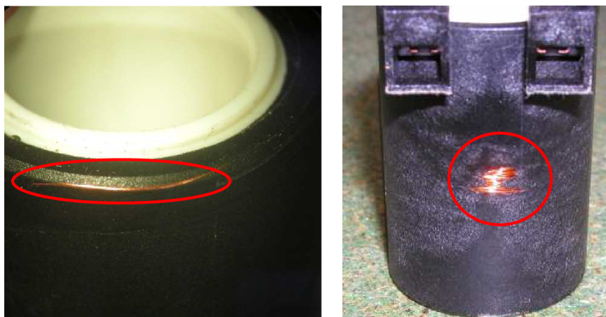
Obr. 5.2 Vinutí prostupující po zapouzdření povrchem pouzdra.
