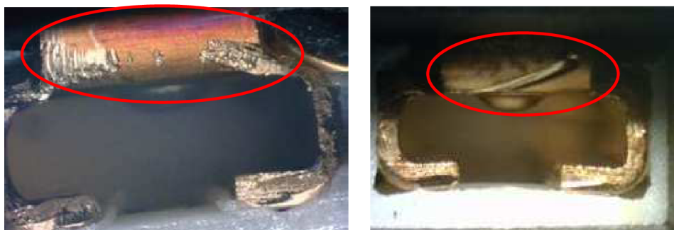
Obr. 5.5 Deformace kontaktu způsobené vkládáním kostky.
