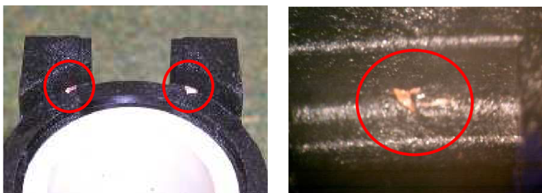
Obr. 5.4 Vyčnívající drát zezadu kontaktu vlevo, vyčnívající drát v kontaktu vpravo.
