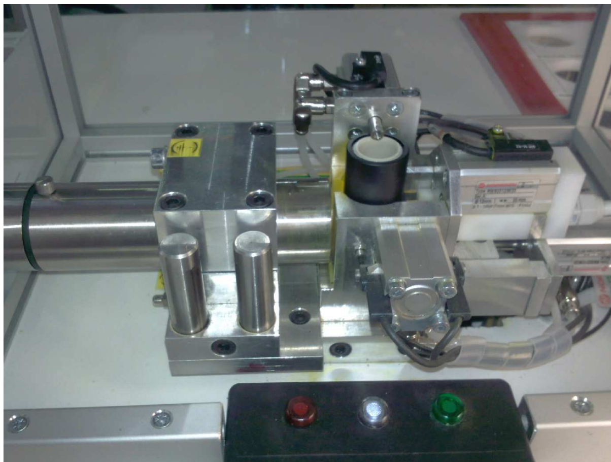
Obr. 3.15 Přípravek pro měření elektrického odporu (v průběhu měření).
