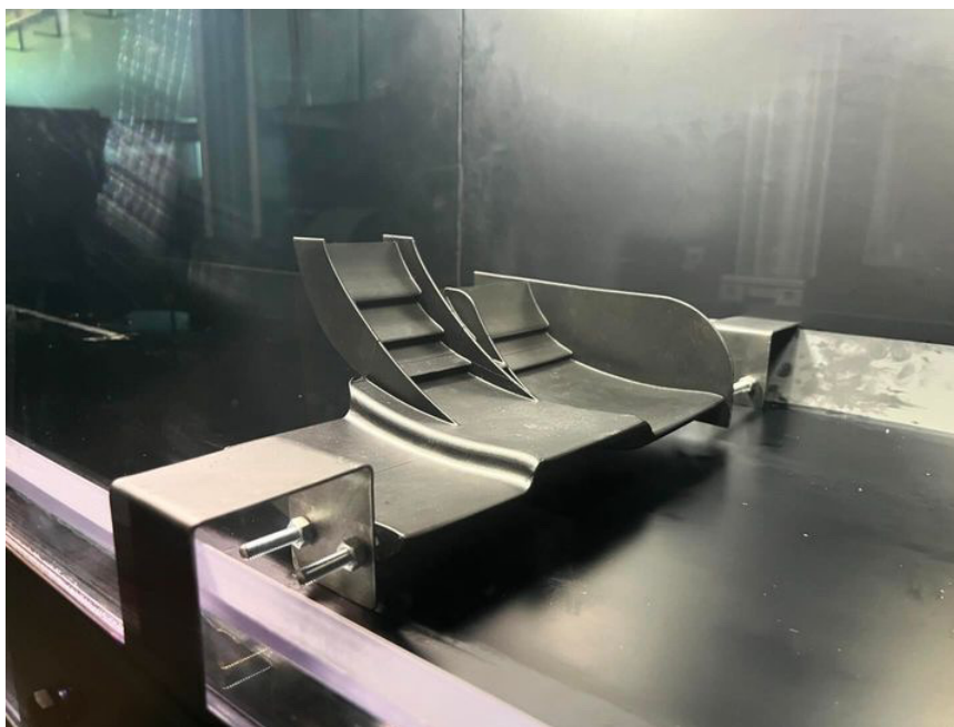
Obr. 22 Křídlo ukotvené v tunelu
