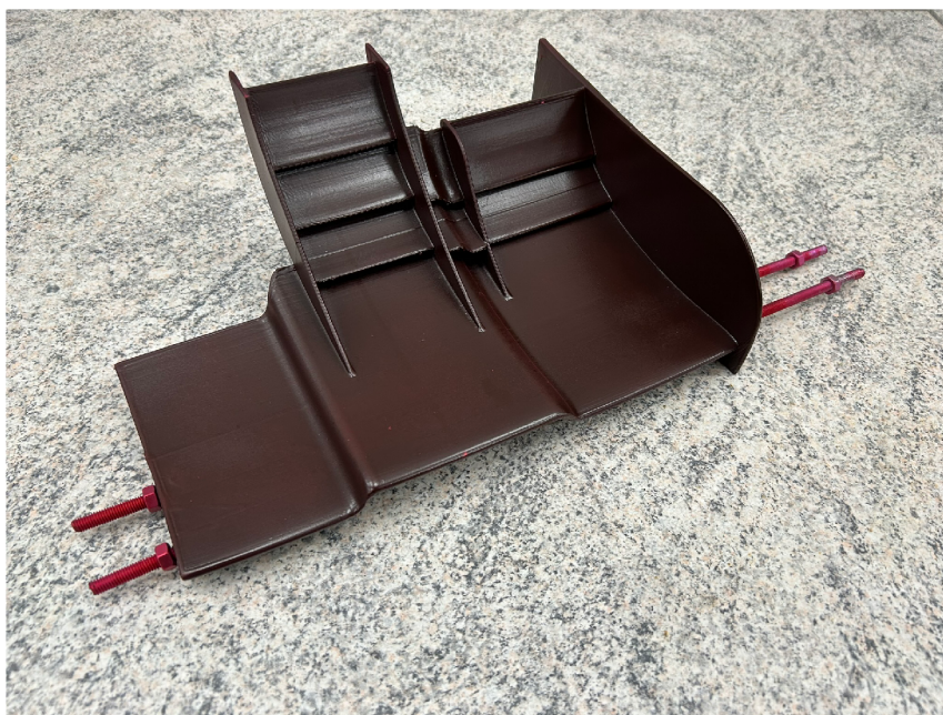
Obr. 23 Křídlo 2023 po nástřiku barvou s příměsí Rhodaminu 5G
