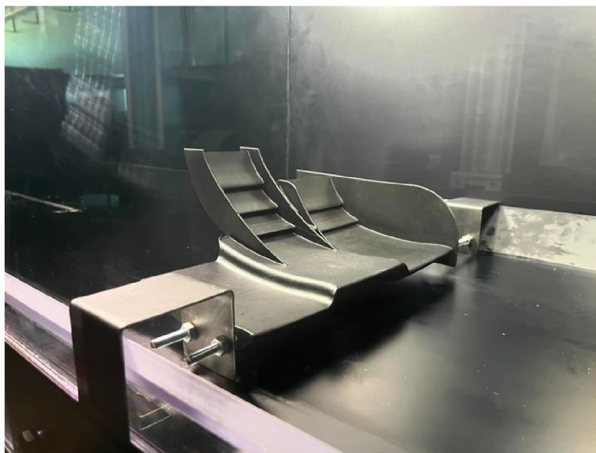
Obr. 22 Křídlo ukotvené v tunelu
