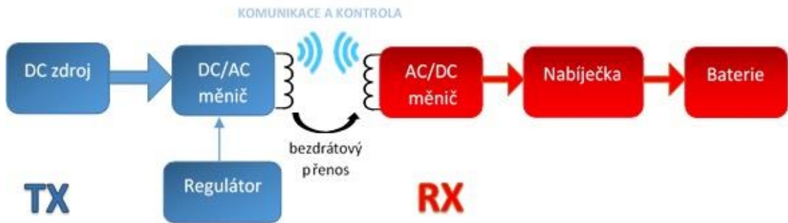
Obr. 3: Obecné blokové schéma pro bezdrátové nabíjení
