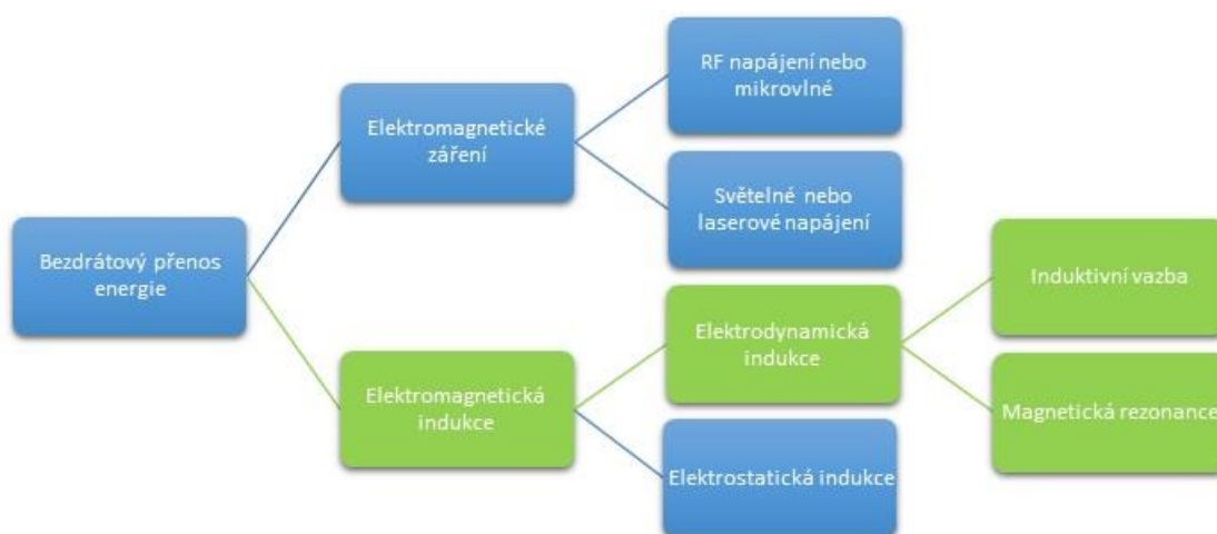
Obr. 1: Obecné schéma pro bezdrátový přenos energie
