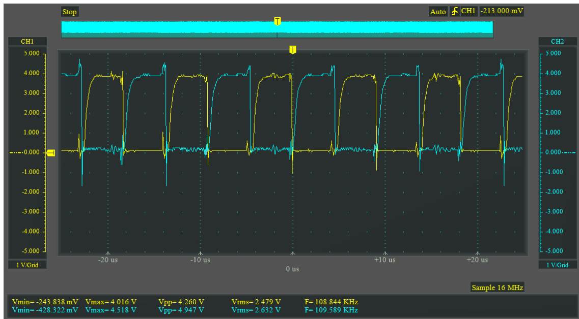
Obr. 50: Měření výstupů komparátoru LM319
