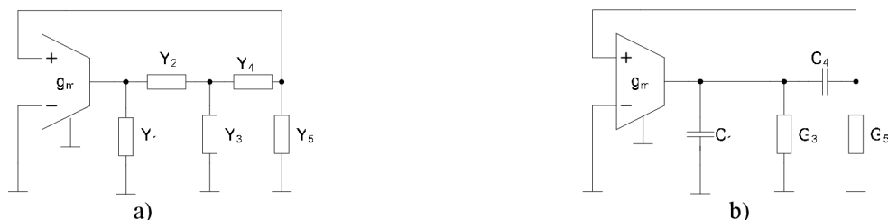
Obr. 1. Filtr s OTA a pěti admitancemi. Autonomní obvod (a) a konkrétní varianta zapojení (b).
