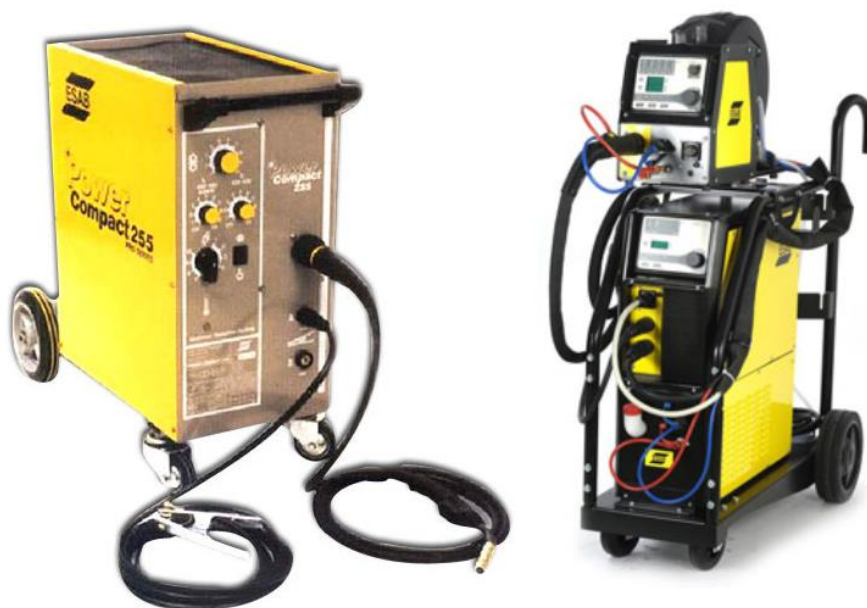
Obr. 3 Svařovací zdroj (vlevo - usměrňovač, vpravo - invertor) [7].
