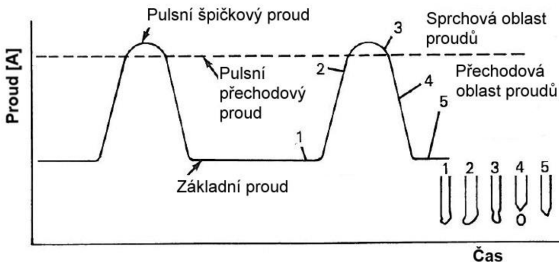
Obr. 10 Pulsní charakteristika oblouku [15].
