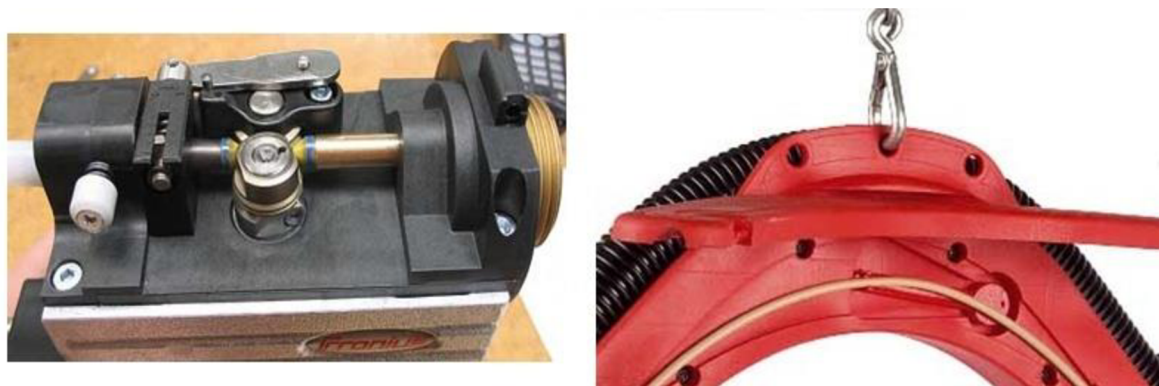
Obr. 14 Podavač drátu se servomotorem (vlevo) a pufrovací zásobník drátu (vpravo) [16].
