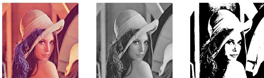
Obrázek 6 – barevný obraz konvertovaný na šedotónový a dále pak na binární obraz
