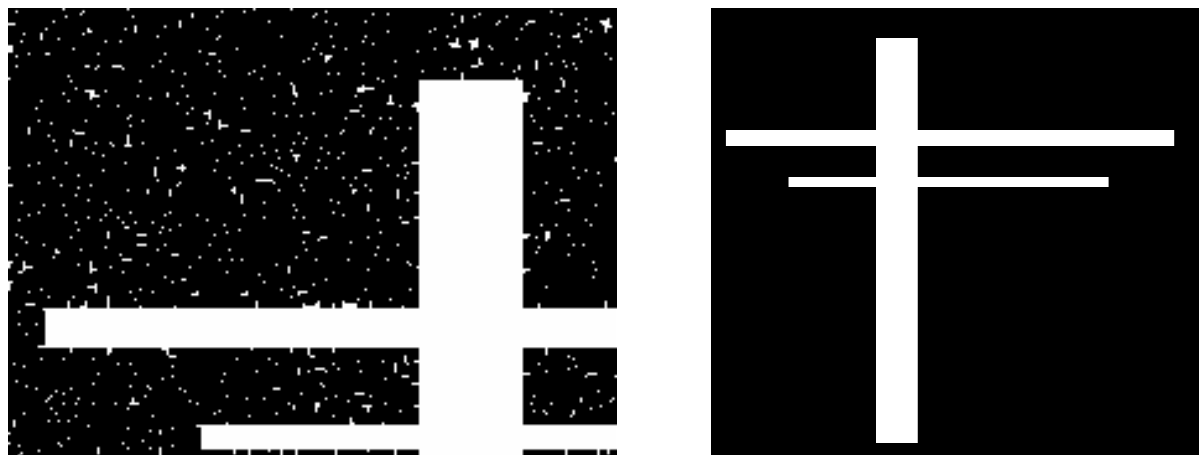
Obrázek 36 – detail obrazu po operaci otevření a obraz zcela bez šumu
