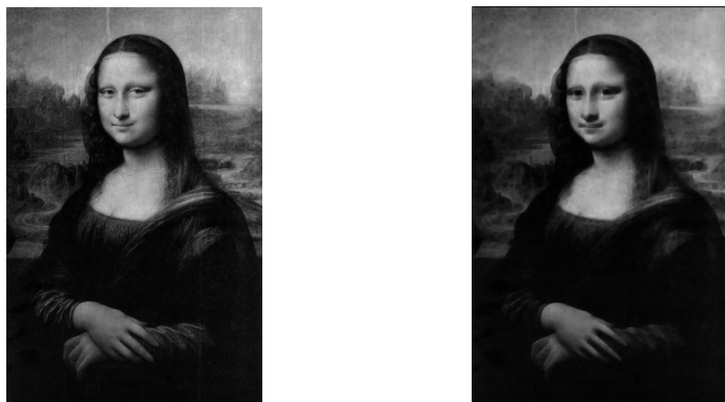
Obrázek 22 - původní obraz a obraz erodovaný čtvercovým elementem 3x3
