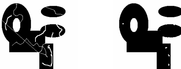
Obrázek 17 - původní obraz a obraz po operaci uzavření čtvercovým elementem 3 \times 3
