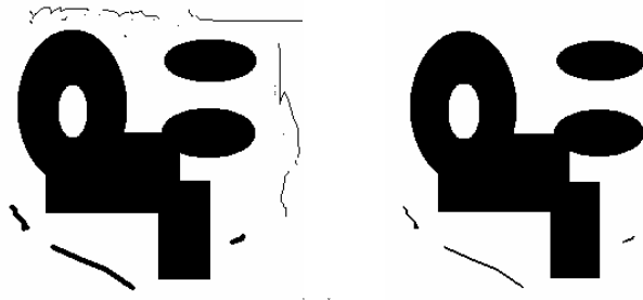
Obrázek 14 - původní obraz a obraz erodovaný čtvercovým elementem 3x3
