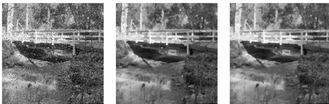
Obrázek 34 - obraz zašuměný šumem pepř a sůl, obraz filtrovaný morfologickým filtrem otevření-zavření čtvercem 2x2 a obraz filtrovaný mediánovým filtrem
