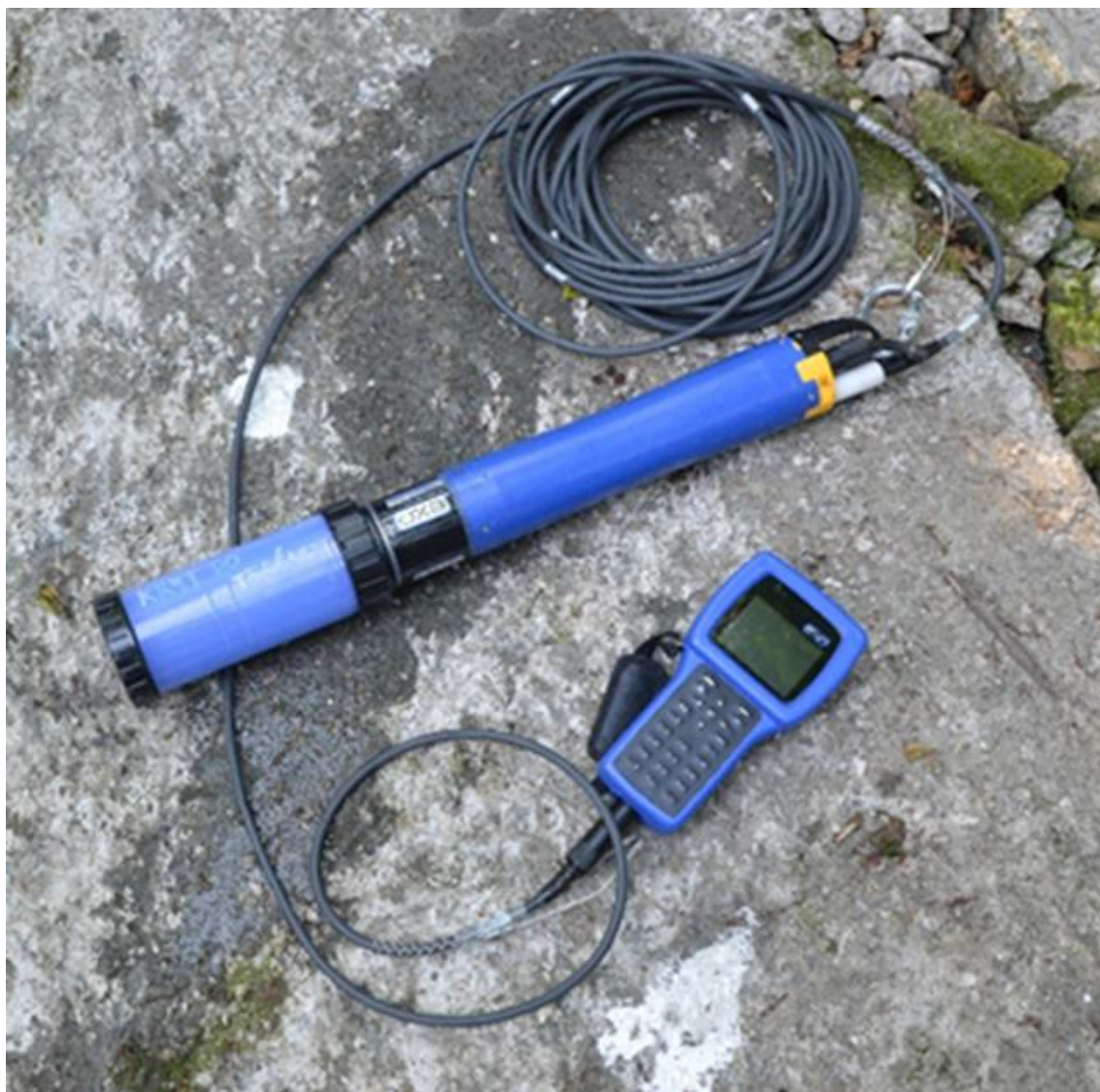
Obr. 3.1.1 Multiparametrální sonda YSI EXO 2 (foto Regenda)
