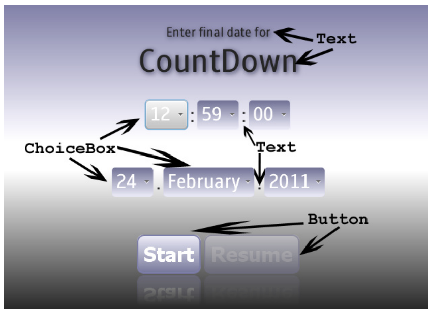
Obrázek 3.1: Použití objektů tříd ChoiceBox, Button a Text pro aplikaci Countdown
