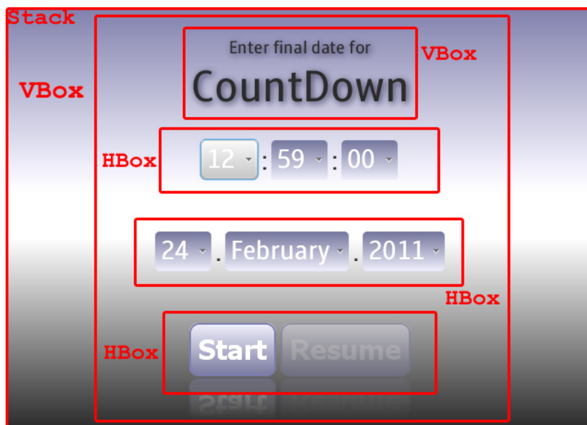
Obrázek 3.2: Umístování objektů pomocí kontejnerů Stack, VBox a HBox ve třídě Settings
