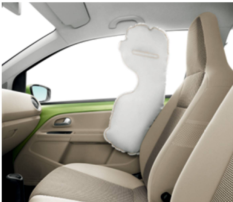
Obr. č. 18. - Boční airbag Škoda s funkcí Head-Thorax
