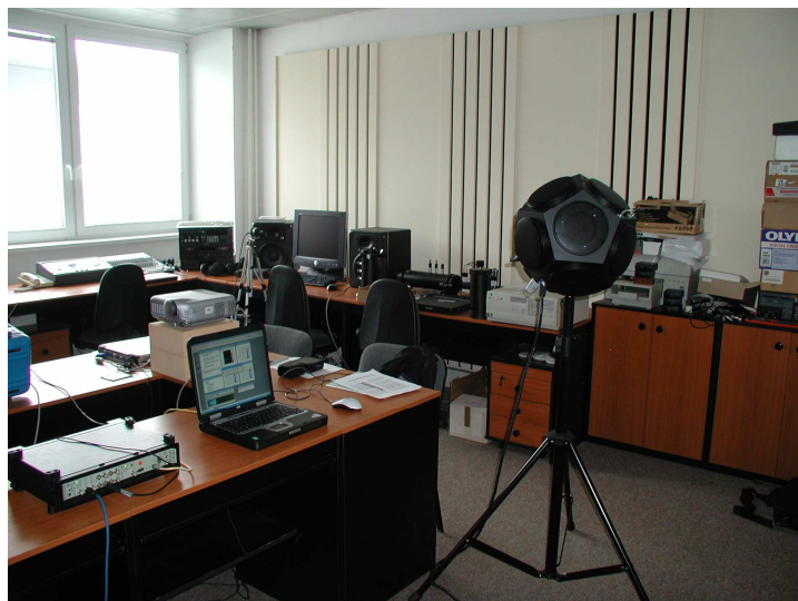
Obr 3.2 Poslechová místnost - současný stav (na obrázku jsou vidět kmitající panely a štěrbinové rezonátory)
