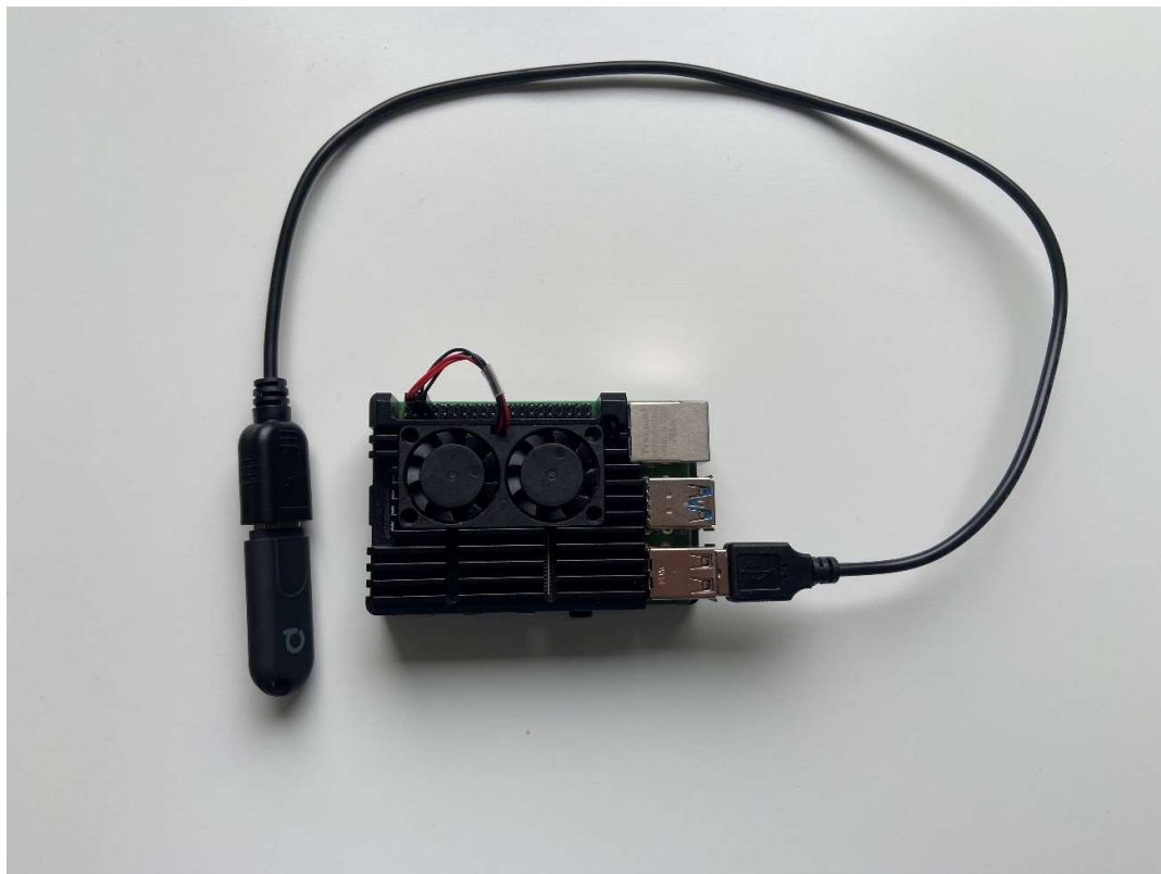
Obrázek 26 - Raspberry Pi s Conbee II (zdroj: vlastní)
