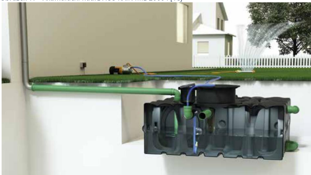
Obrázek 17 - Akumulací nádrž ACO RAIN4ME 2000 I [18]
