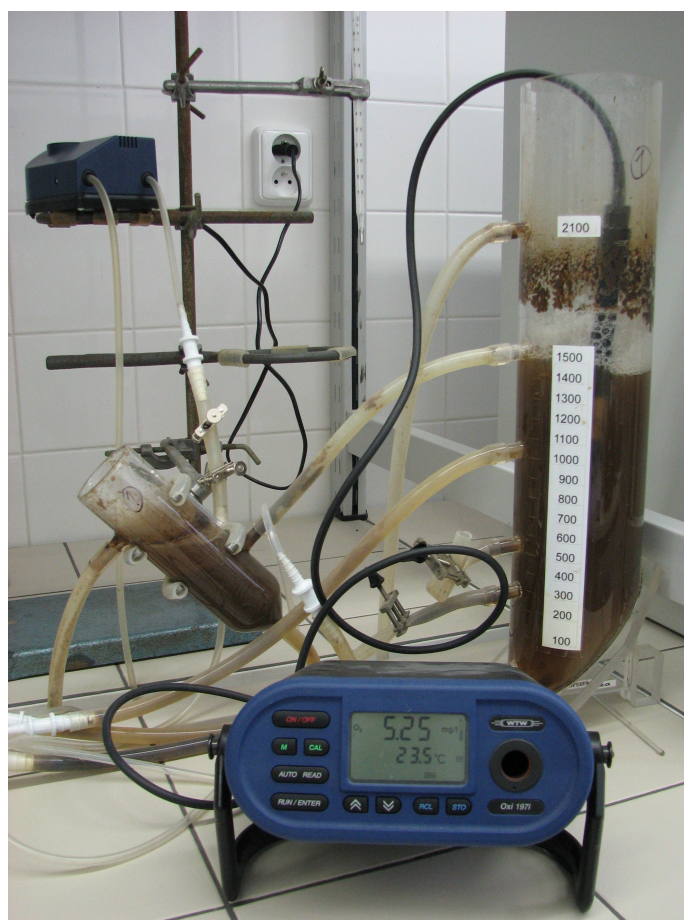
Obrázek č. 5: Měření hladiny rozpuštěného kyslíku oximetrem v reaktoru.
