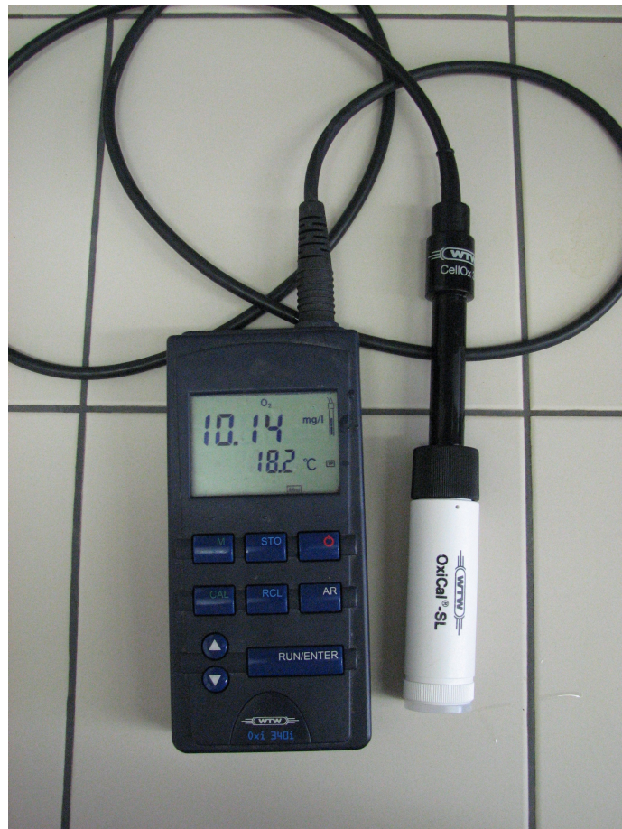
Obrázek č. 4: Oximetr se sondou v kalibrační nádobce.
