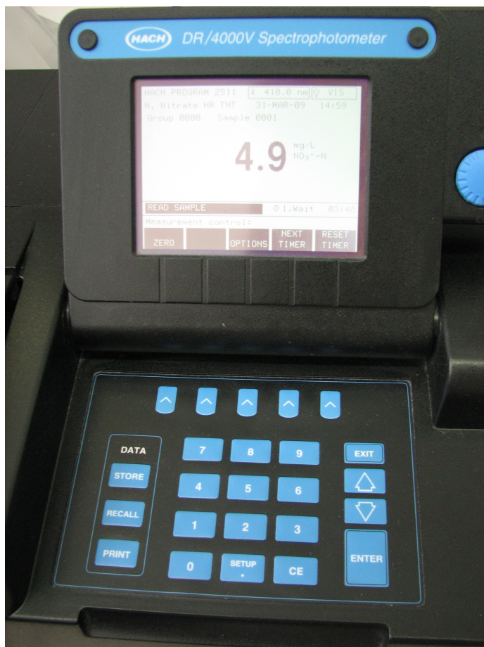
Obrázek č. 7: Spektrofotometrické měření koncentrace dusičnanů ve vzorku.
