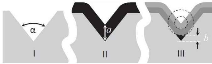
Obr. 3.3 Rohová litografie. \alpha je vrcholový úhel jamky, a tloušťka sacrificial layer, b tloušťka zbytkové sacrificial layer po odleptání [63]
