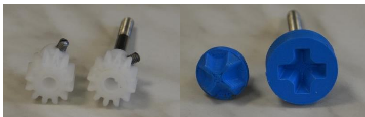
Obr. 4.8 Čelní ozubené soukolí a kuželové soukolí (šrouby M4)
