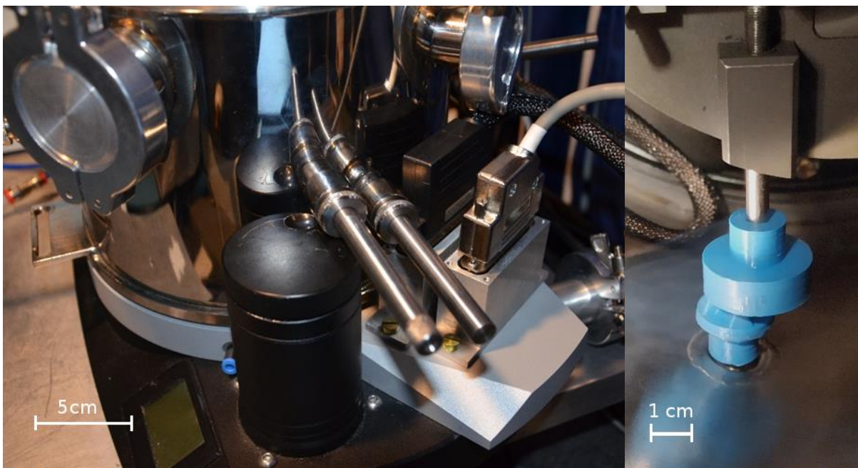
Obr. 4.10 Vlevo pohled na manipulátory SX a LF šroubu. Vpravo detail vyosení kuželovitého soukolí
