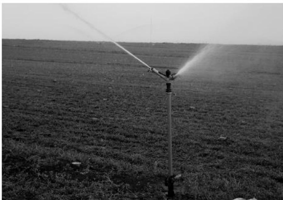
Obr. č. 13: Příklad zavlažovače použitého pro měření CU (Maroufpoor et al., 2010)
