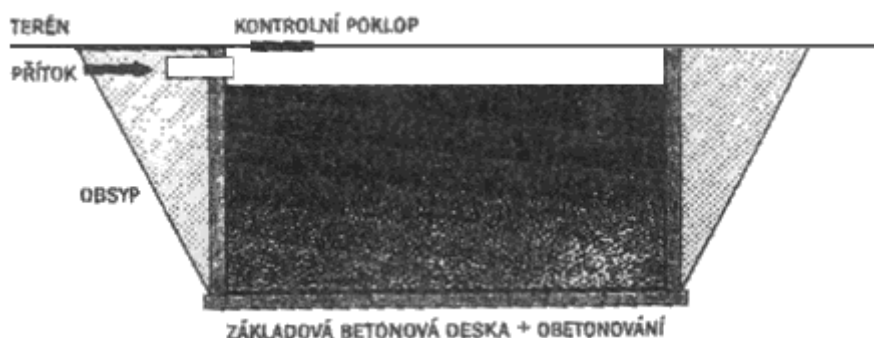
Obr. 6 Žumpa – bezodtoková jímka
