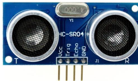
Obrázek 16 Modul HC-SR04 a jeho výstupy [14]
