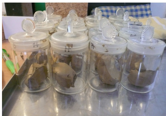
Obr. 21 Váženky se suspenzí z penetrometru
