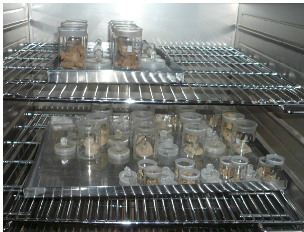
Obr. 25 Sušení zeminy ze zkoušek konzistence
