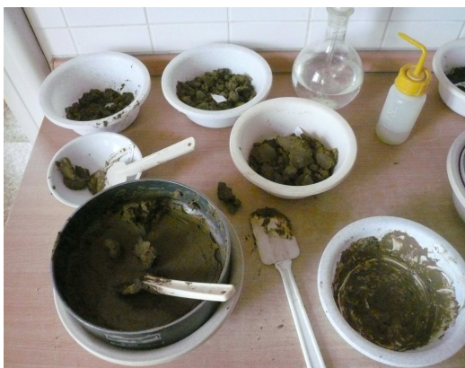
Obr. 20 Protírání přes síto 0,5 mm
