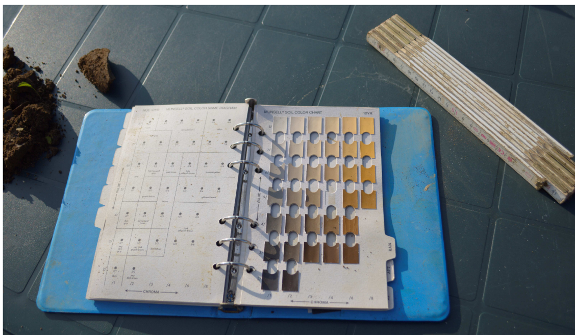
Obr. 15 Vzorkovník pro určení barvy zeminy
