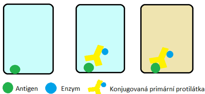
Obrázek 1: Schématické znázornění přímé ELISA: vazba antigenu na jamku (vlevo), přidání enzymem značené protilátky (uprostřed), přidání substrátu (vpravo).
