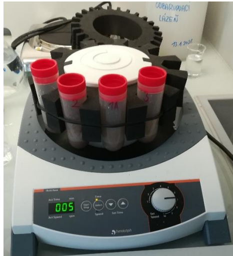
Obrázek 13: Třepání vzorků s HCl na třepačce ReaxMulti
