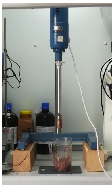
Obrázek 8: Homogenizátor Ultra-Turrax, pomocí nějž byly vzorky zhomogenizovány.
