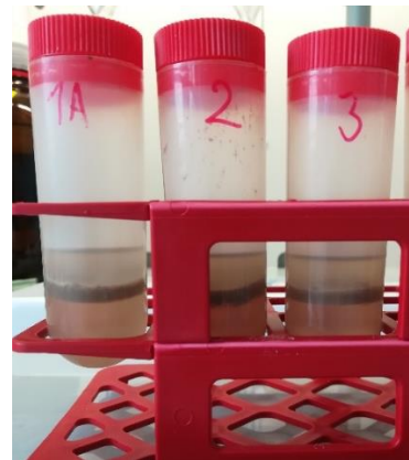
Obrázek 15: Zcentrifugované vzorky se třemi viditelnými vrstvami
