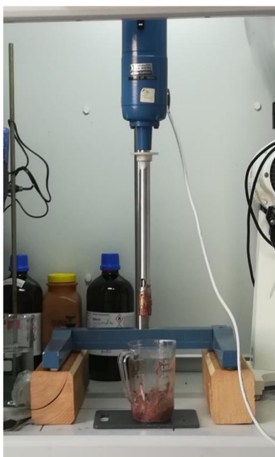
Obrázek 8: Homogenizátor Ultra-Turrax, pomocí nějž byly vzorky zhomogenizovány.
