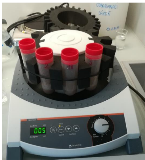
Obrázek 13: Třepání vzorků s HCl na třepačce ReaxMulti
