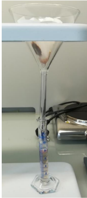
Obrázek 16: Filtrační aparatura s odděleným koláčem vzorku a organickou fází jako filtrátem
