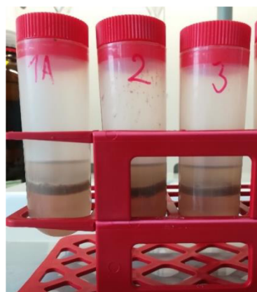
Obrázek 15: Zcentrifugované vzorky se třemi viditelnými vrstvami
