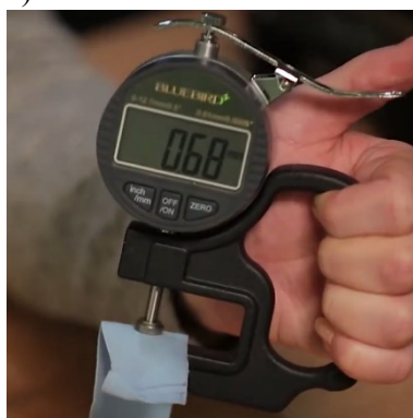
Obr. 36 Stanovení tloušťky plošné textilie a) pomocí soupravy CLO Fabric Kit [48], b) pomocí přístroje MO34A firmy SDL International (fotografie z měření), c) fotografie švu, jehož tloušťka byla měřena na přístroje MO34A
