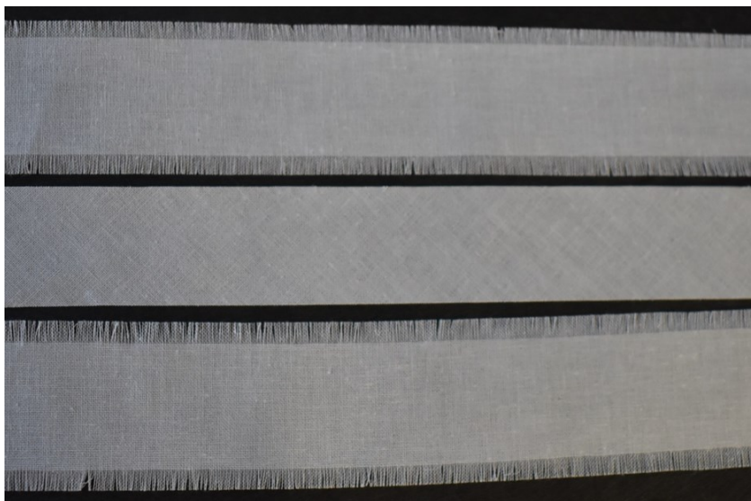
Obr. 39 a) Testometric M350-5CT; b) sada vzorků tkaniny BP145 střížených po osnově (na fotografii nahoře), diagonále, útku (na fotografii dole)
