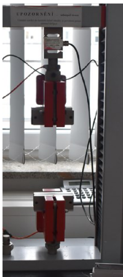
Obr. 39 a) Testometric M350-5CT; b) sada vzorků tkaniny BP145 střížených po osnově (na fotografii nahoře), diagonále, útku (na fotografii dole)
