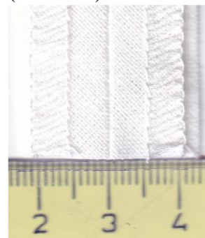
Obr. 36 Stanovení tloušťky plošné textilie a) pomocí soupravy CLO Fabric Kit [48], b) pomocí přístroje MO34A firmy SDL International (fotografie z měření), c) fotografie švu, jehož tloušťka byla měřena na přístroje MO34A
