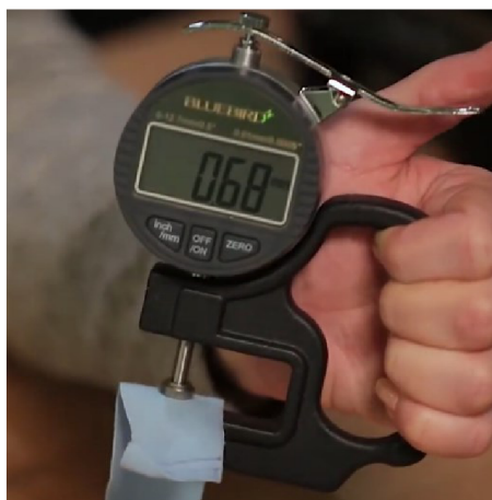
Obr. 10 CLO Fabric Kit 2.0: tloušťkoměr (obr. vlevo); stanovení tuhosti v ohybu (obr. vpravo) – kontaktní délka L1, délka proužku L2 [48]
