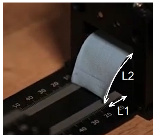
Obr. 10 CLO Fabric Kit 2.0: tloušťkoměr (obr. vlevo); stanovení tuhosti v ohybu (obr. vpravo) – kontaktní délka L1, délka proužku L2 [48]
