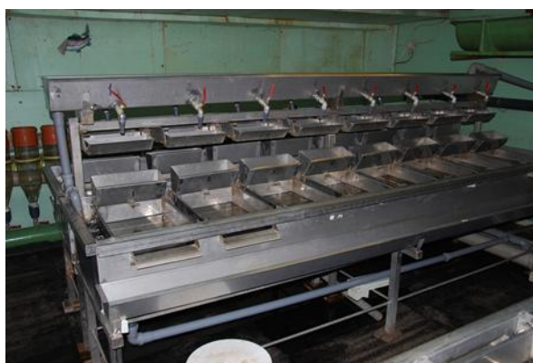
Obr. č. 4. Inkubace jiker v aparátech typu „OSJETER“ (rybí farma Fischzucht Peter und Udo Gross GmbH & Co. KG, Německo), (foto V. Kašpar).
