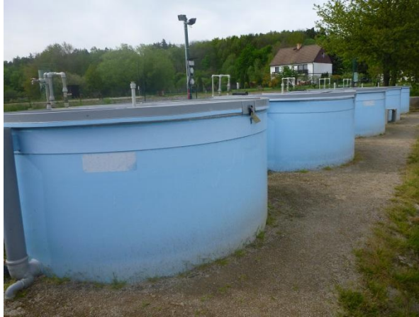
Obr. č. 25. Venkovní plastové kruhové nádrže určené k odchovu rozkrmených ryb (foto M. Kahanec).
