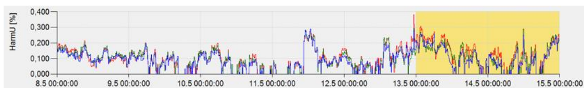
Obrázek 8.9: Měření napětí 11. harmonické v uzlu B400
