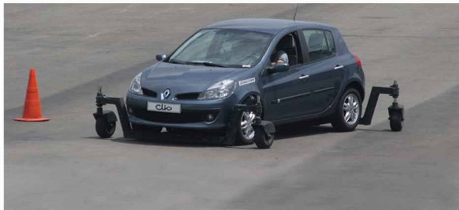
Obr. 8 Praktická jízda se zařízením SKIDCAR
