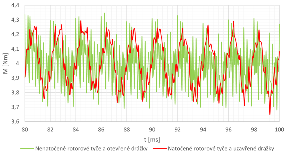
Obr. 6.7 Časový průběh momentu v ustáleném stavu při použití otevřených drážek s nenatočenými tyčemi a uzavřených rotorových drážek s natočenými tyčemi
