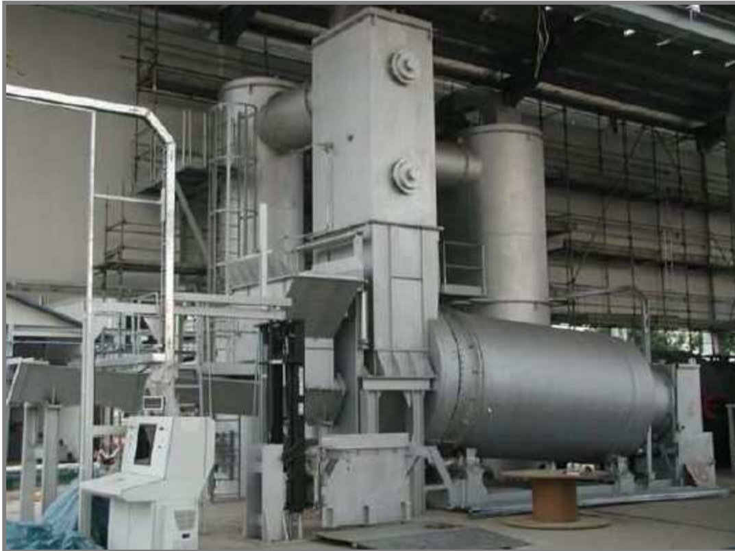
Obr. 12: Reálné provedení RP s protiproudým uspořádáním [33]
