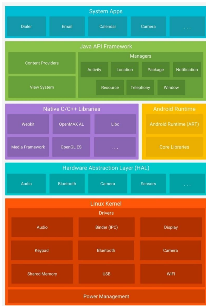
Obrázek 3 - schéma architektury Android OS, zdroj: www.developer.android.com , 2021
